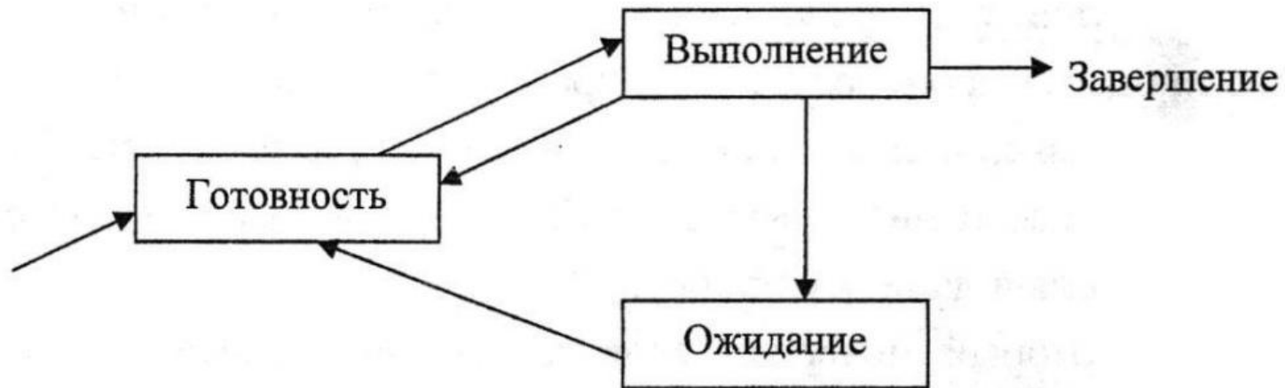
Рис. 17. Граф состояний процесса в многозадачной среде
