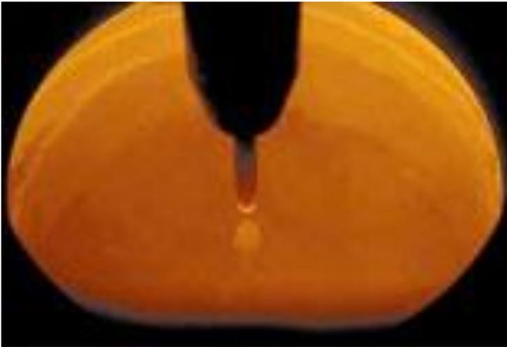
Выращивание шейки осуществляется для того, чтобы предотвратить прораствание дислокаций, образованных в результате термического удара, в объем растущего монокристалла.
