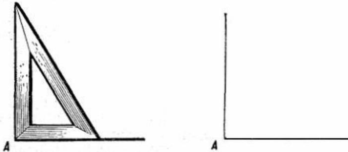
Если проводить вторую сторону прямого угла, не сдвигая угольника вниз, а при таком его положении, какое показано на рис., то либо линия не дойдет до точки А (рис.а), либо карандаш, соскочив с края угольника, прочертит кривую (рис. б).
