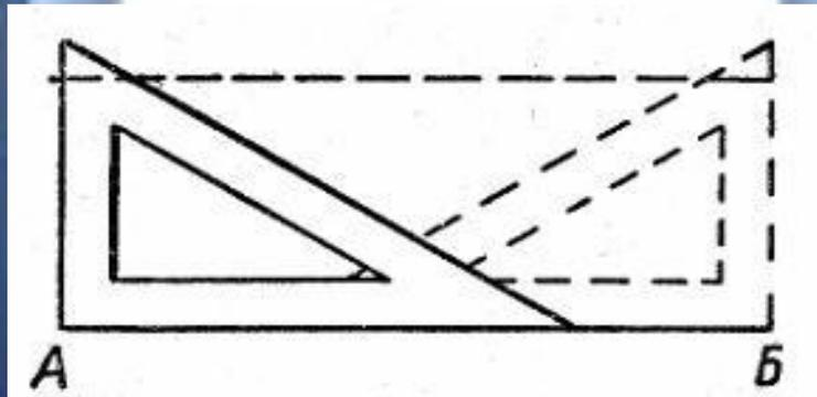
На обозначенных направлениях откладываются боковые стороны заданной длины. Полученные точки последовательно соединяются отрезками прямых. Чтобы проверить, насколько правильно построен прямоугольник, следует произвести контрольный замер стороны, противоположной стороне А Б.
