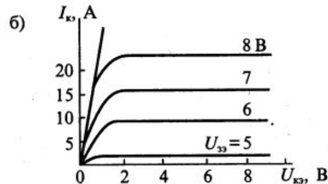
Рис.3 Схема замещения IGBT (а) и его выходные вольт-амперные характеристики (б)
