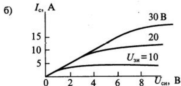
Рис.1 Схема замещения полевого транзистора с индуцированным каналом по технологии вертикального канала (а) и его выходные вольт-амперные характеристики
