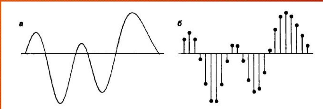
Рис. 3. Преобразование звукового сигнала в дискретный сигнал: а — звуковой сигнал на входе АЦП; б — дискретный сигнал на выходе АЦП
