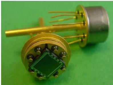
Имеют большую временную и температурную стабильность по сравнению с преобразователями на основе КНС – структур.
