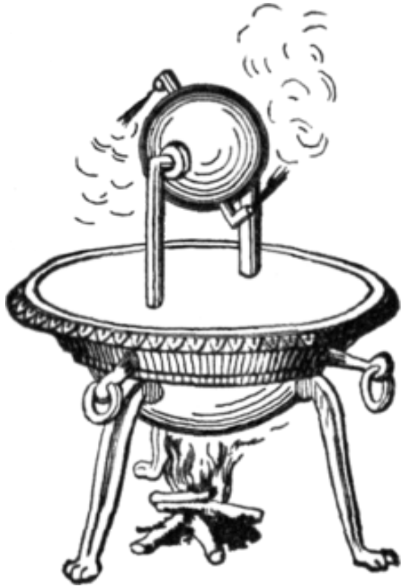
Паровая турбина Герона.
