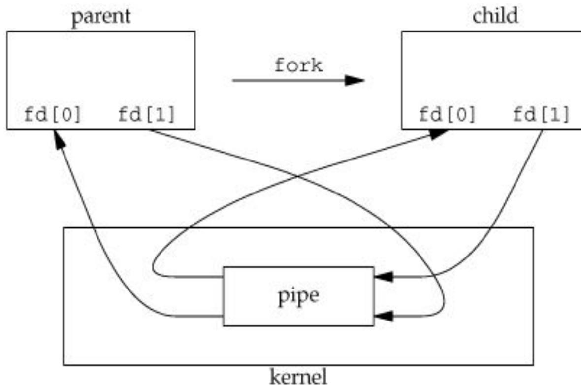
Каналы не поддерживают произвольный доступ, т. е. данные могут считываться только в том же порядке, в котором они записывались.
