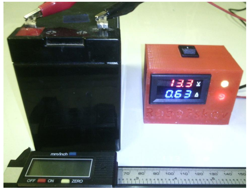
Зарядка свинцово-кислотного аккумулятора
