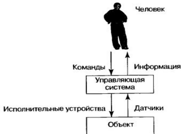
Рис. 1.1. Простая система управления
