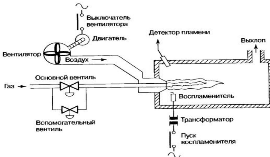
Рис. 1.2. Система управления последовательного действия
