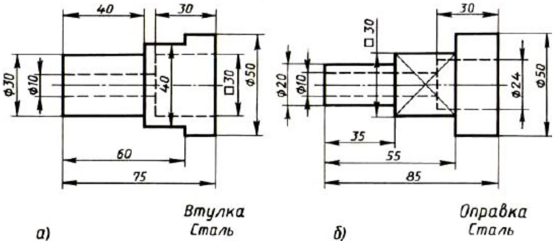
На листе формата А4 выполните вид слева и постройте соединение  $\frac{1}{2}$  вида и  $\frac{1}{2}$  разреза одной из деталей (по вариантам). Нанесите размеры.
