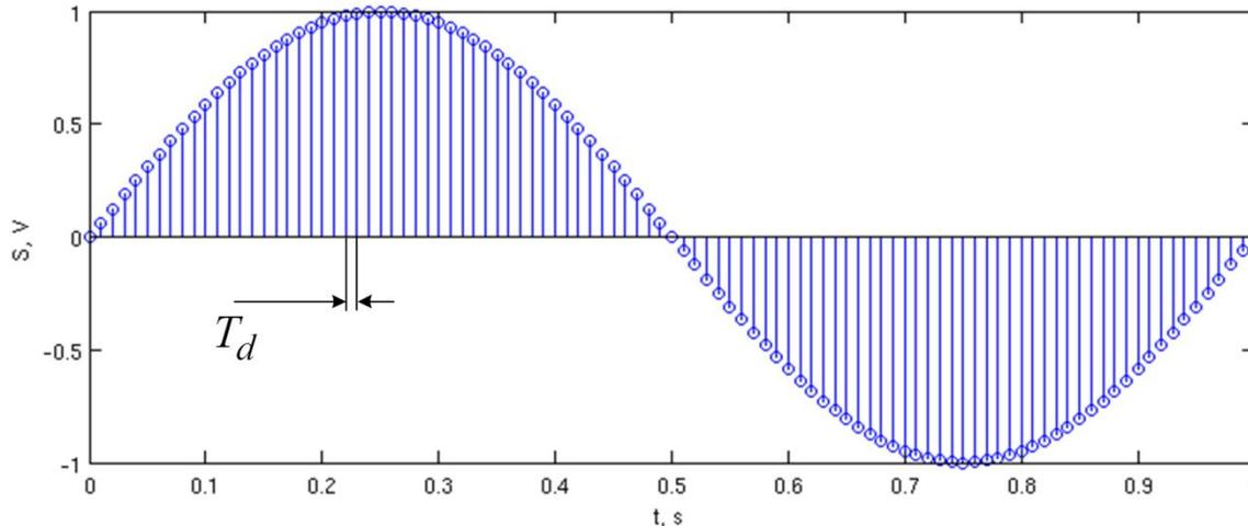
И входные, и выходные сигналы в машине мы представляем в виде **дискретных** последовательностей:
