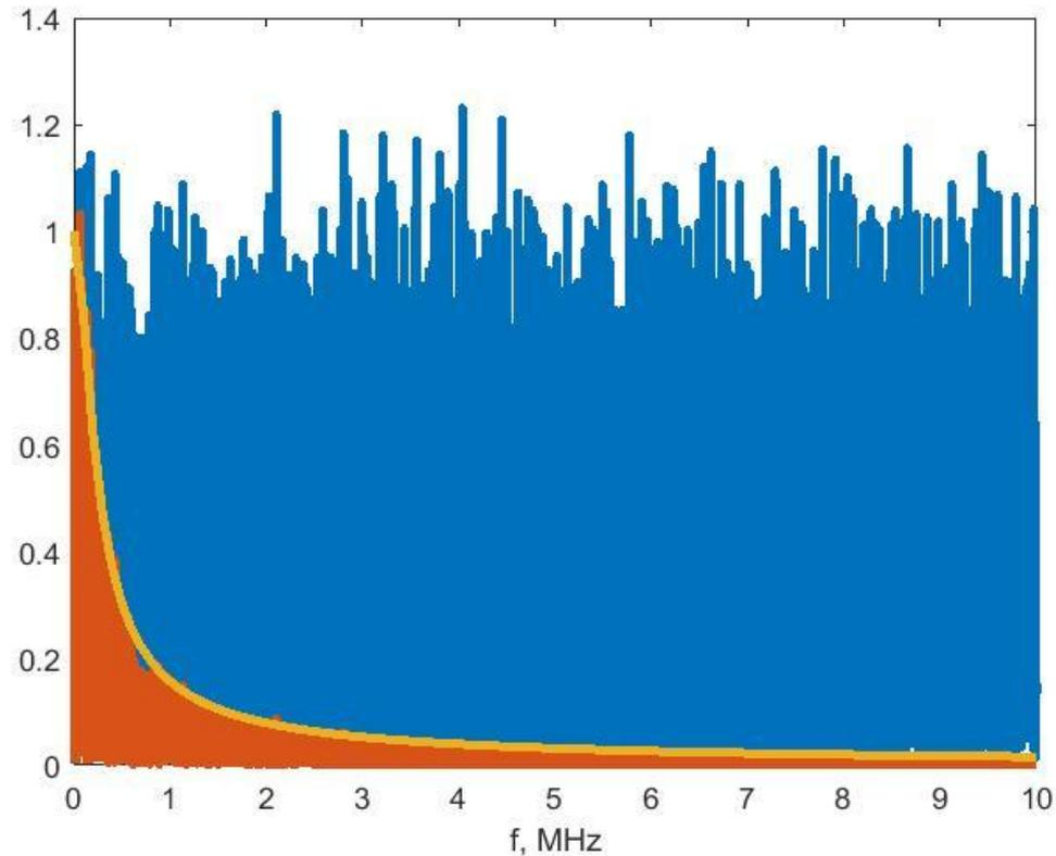
Синий график: модуль спектральной плотности БГШ
