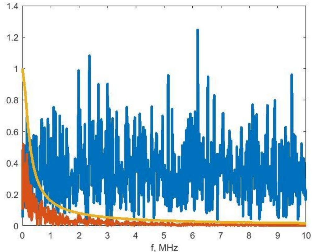
Синий график: модуль спектральной плотности БГШ
