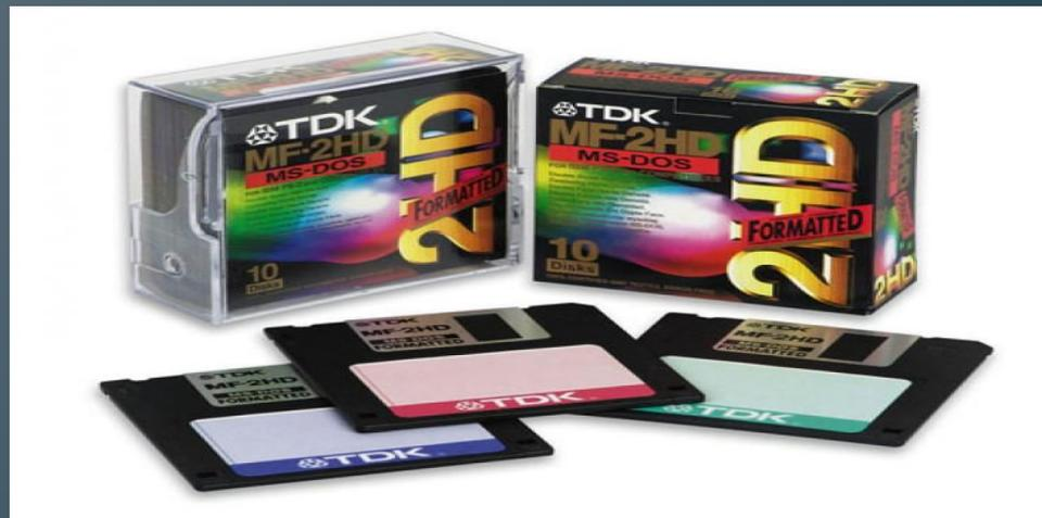
**Дискета** — портативный носитель информации, используемый для многократной записи и хранения данных, представляющий собой помещённый в защитный пластиковый корпус гибкий магнитный диск, покрытый ферромагнитным слоем.
