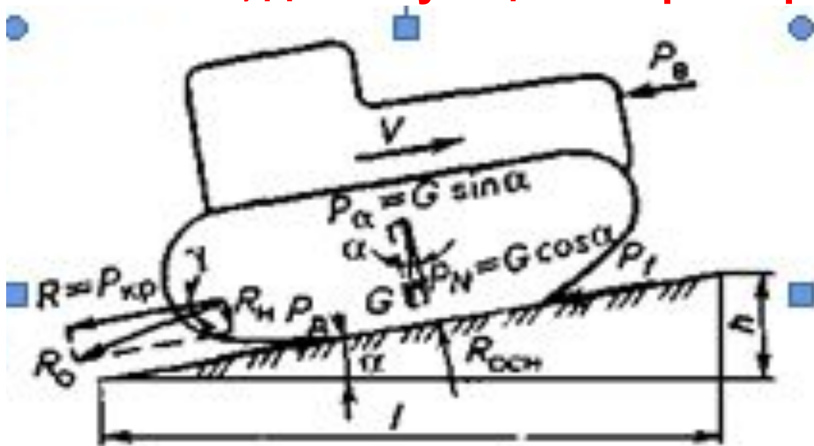
Рис. 2.3. Схема сил, действующих на трактор
