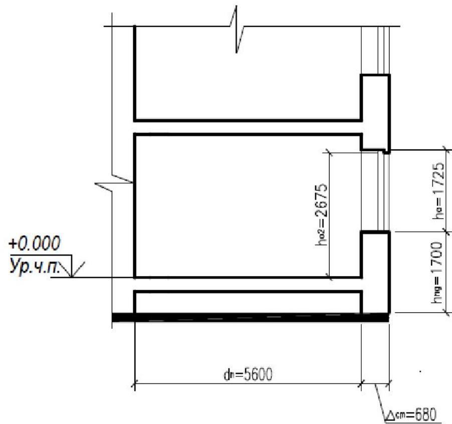
Рис. 1 - Разрез жилой комнаты (предварительный расчет)
