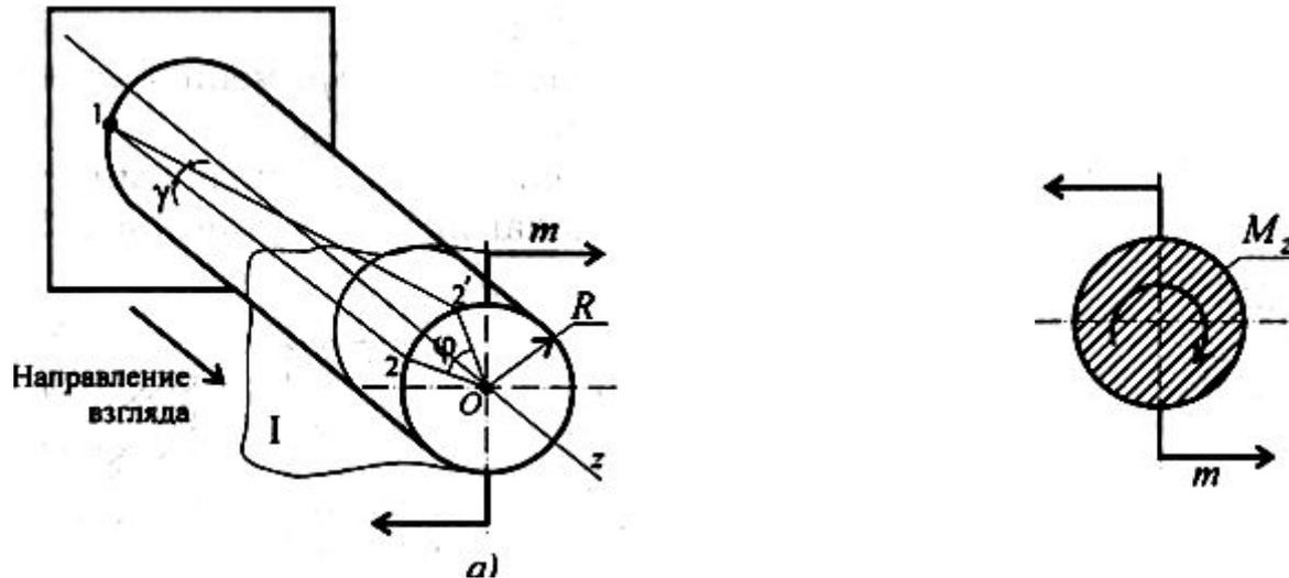
***Крутящий момент определяется методом сечений и в сечении равен сумме моментов внешних сил, действующих на оставшуюся часть***
