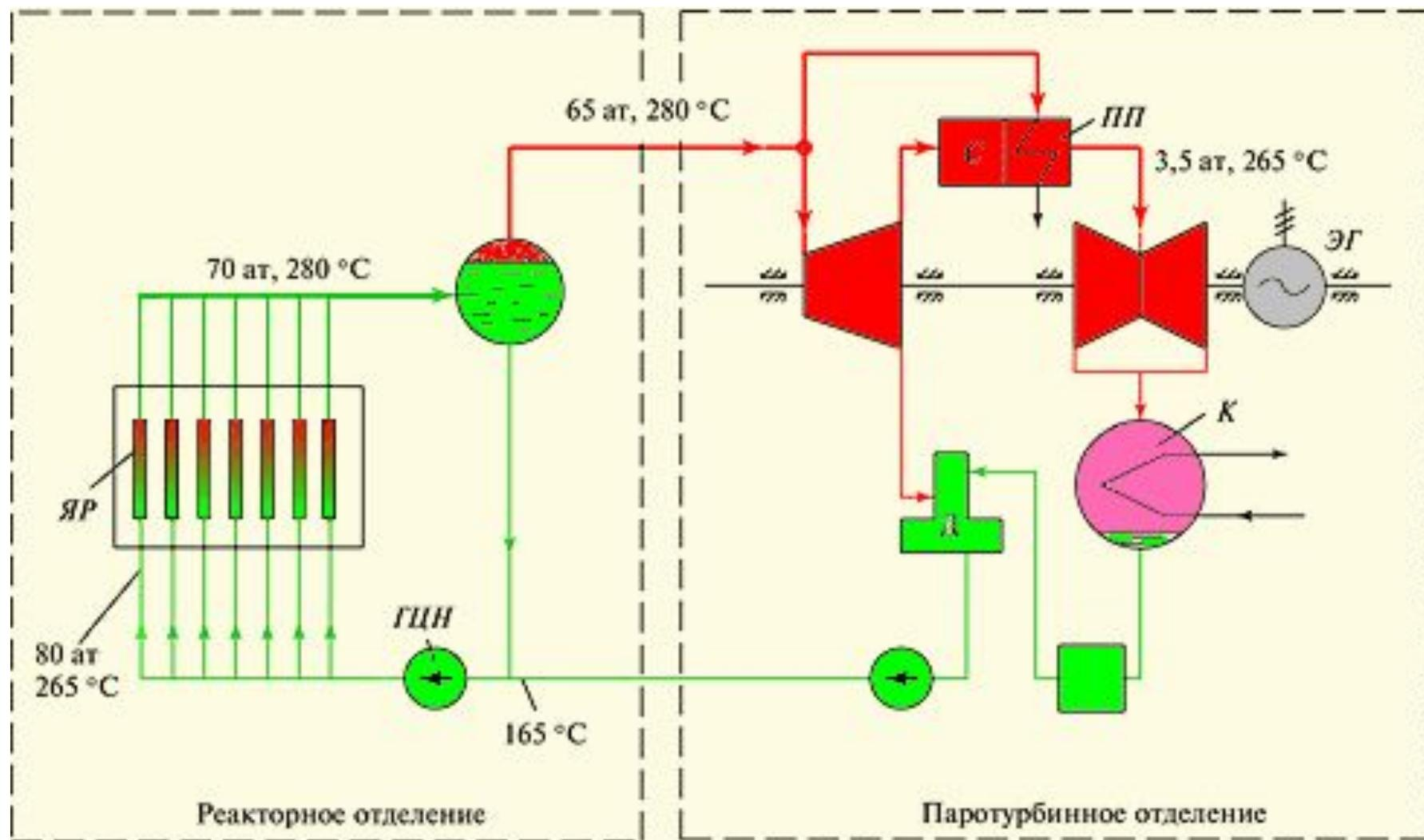
Рис. 5.15. Схема одноконтурной АЭС с каналным реактором РБМК (приведенные цифры относятся к РБМК-1000)
