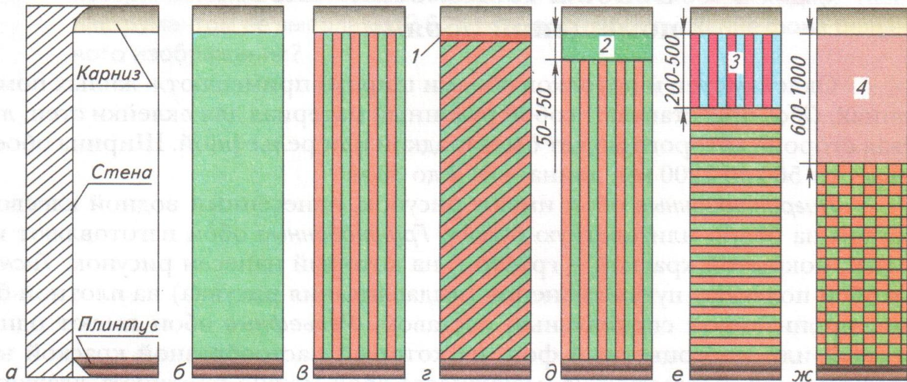
**Рис. 98.** Варианты оклейки стен обоями: *а* — разрез стены; *б* — отделка в один колер; *в* — отделка в два колера; *г* — отделка в два колера с филенкой; *д* — отделка с бордюром; *е* — отделка с фризом; *ж* — отделка с гобеленом: 1 — филенка; 2 — бордюром; 3 — фриз; 4 — гобелен
