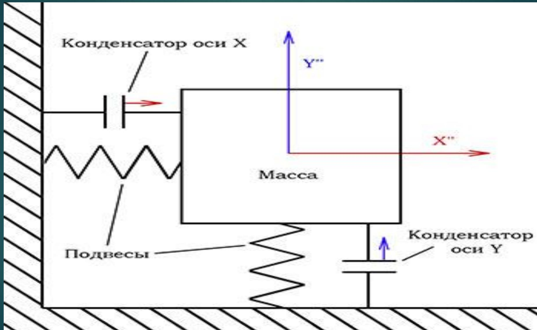
Относительно простой, но чрезвычайно миниатюрный и чувствительный MEMS-акселерометр разработки Sandia Labs
