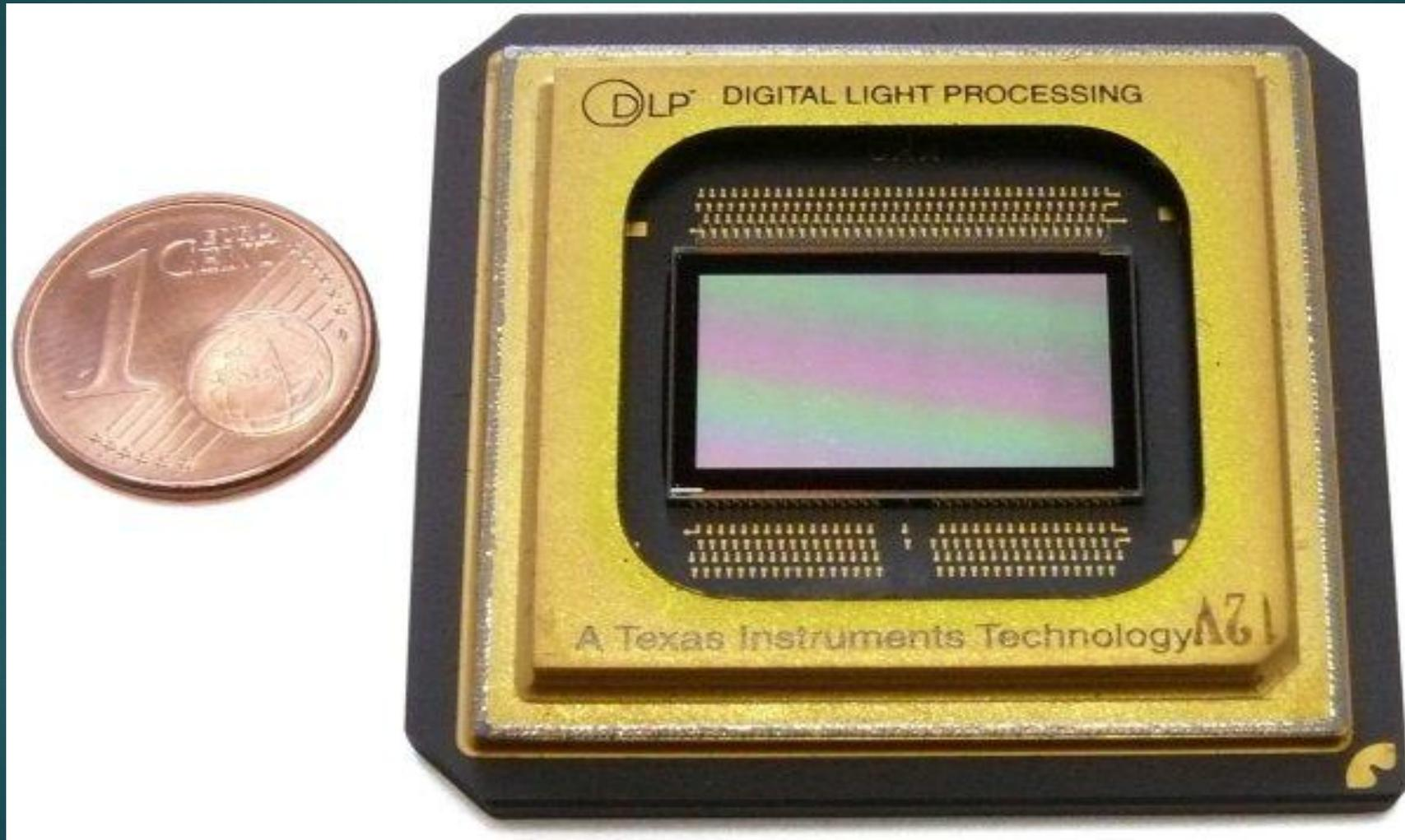
Сами микрозеркала чрезвычайно миниатюрны. На фото изображена одна из старых матриц с размером ячейки 16x16 микрон. В более новых DMD-чипах зеркала еще меньше
