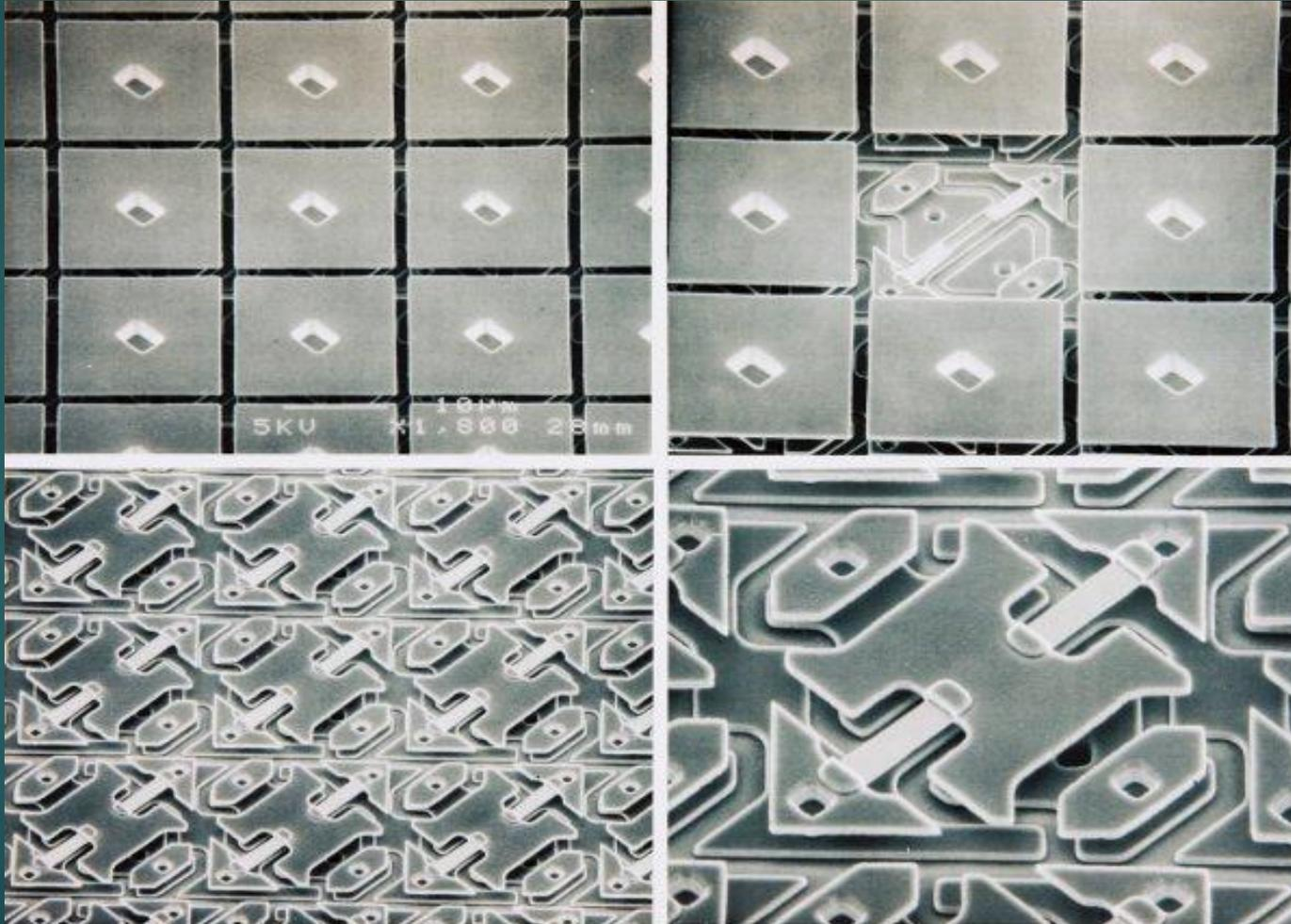
Так устроен каждый из миллионов используемых в микрозеркальной матрице элементов
