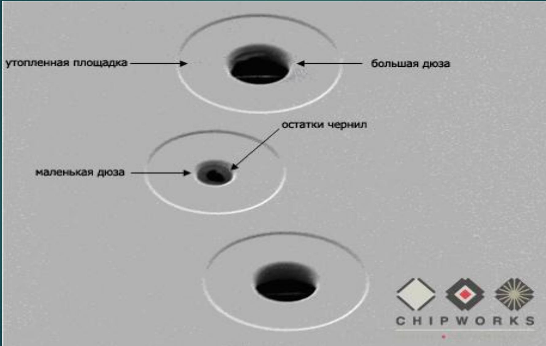
Одна из ячеек печатающей головки HP 60 в разрезе
