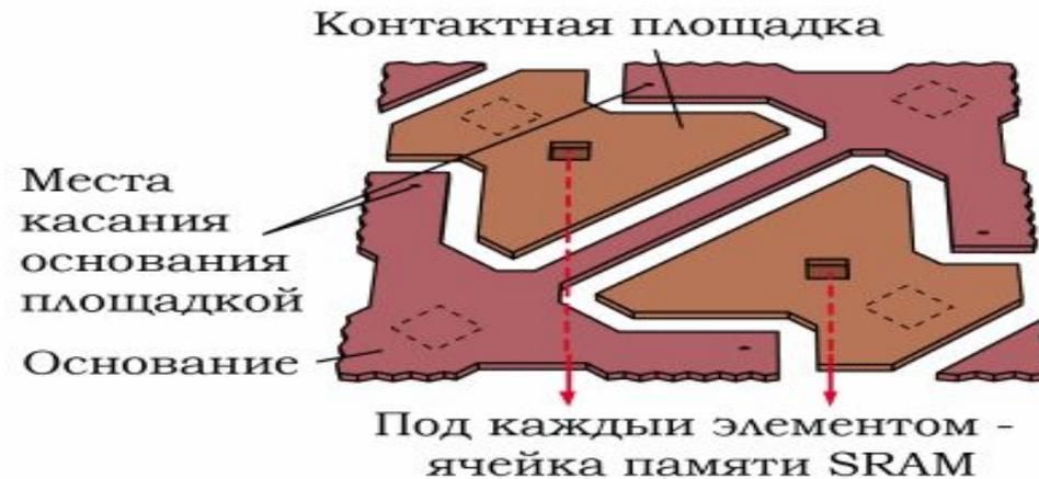
Два микрозеркала. Одно в «черном» положении, другое – в «белом». Среднее – «горизонтальное» – положение зеркала занимают только в припаркованном состоянии, когда проектор выключен
