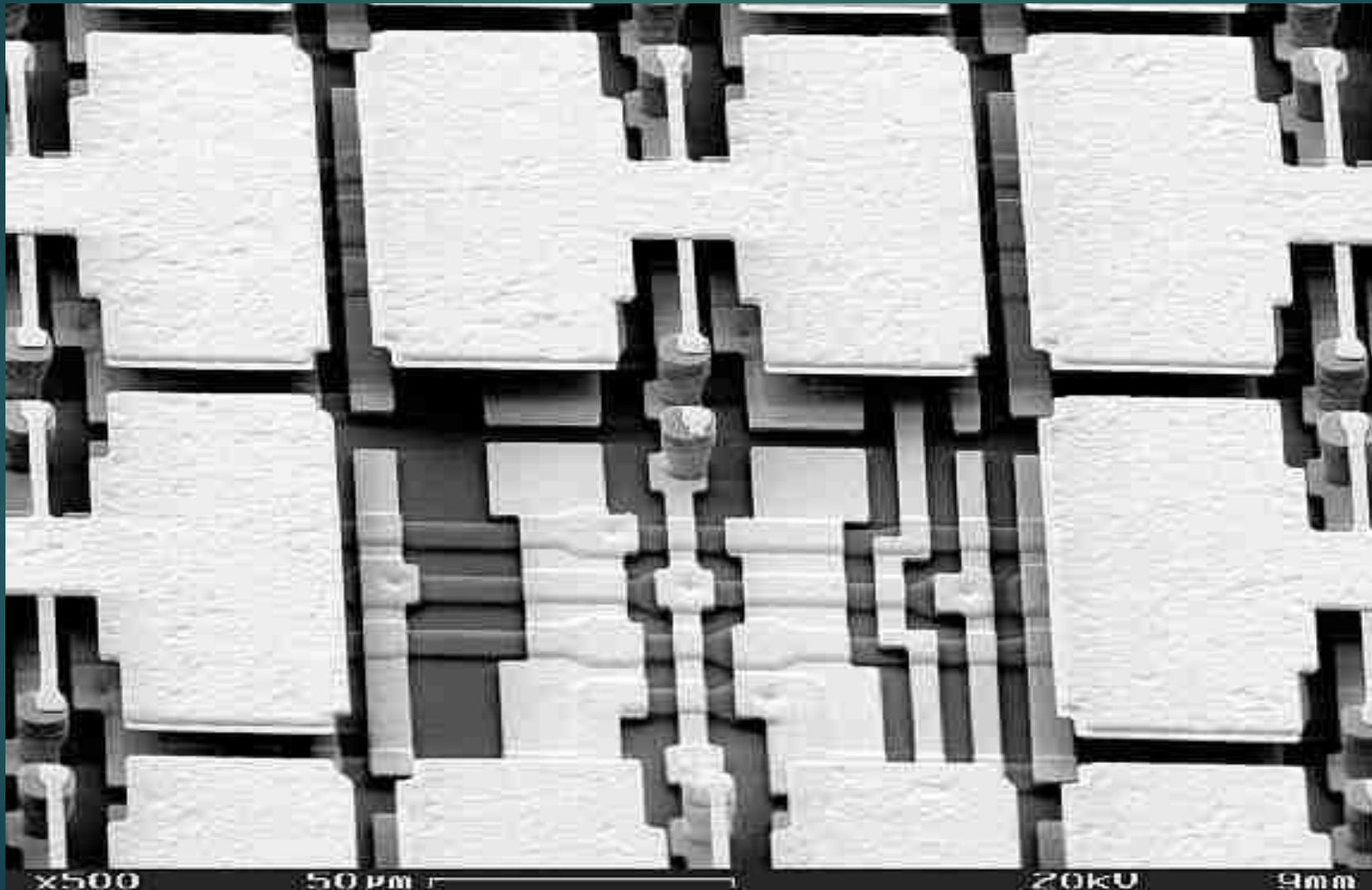
Зеркало с изменяемой геометрией, состоящее из 93 элементов
