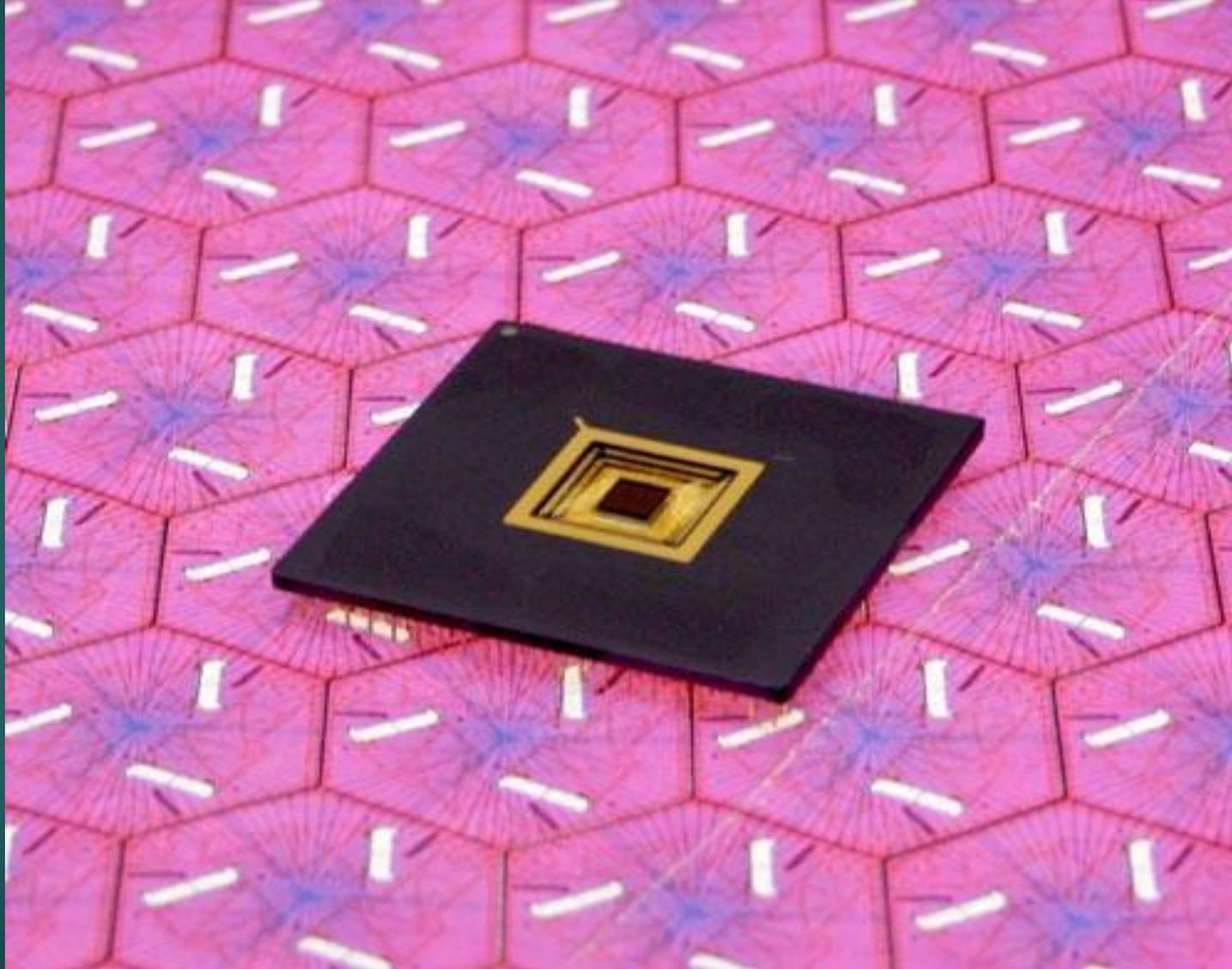
Зеркало с изменяемой геометрией, состоящее из 1020 элементов. Разработка Boston Micromachines Corporation
