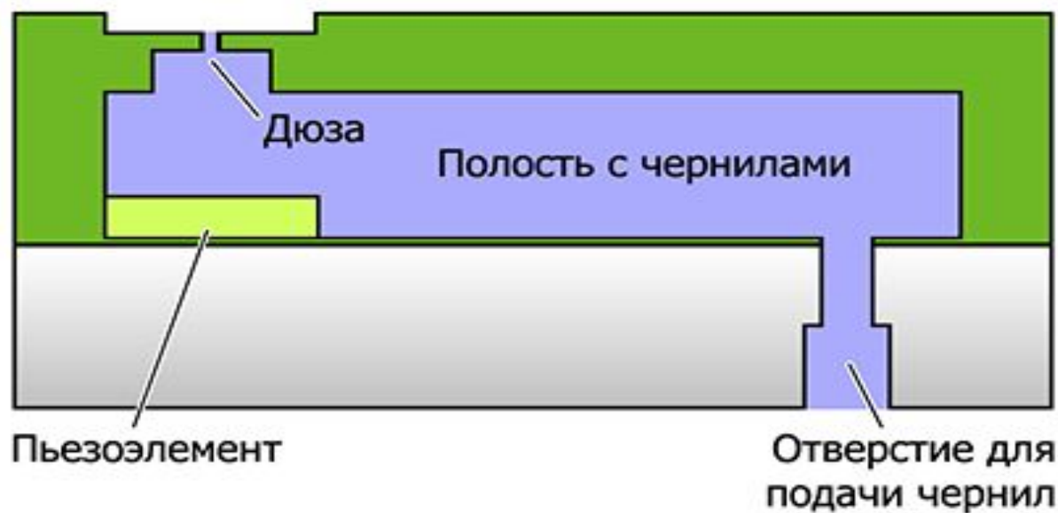
Принцип работы пьезоструйной печатающей головки
