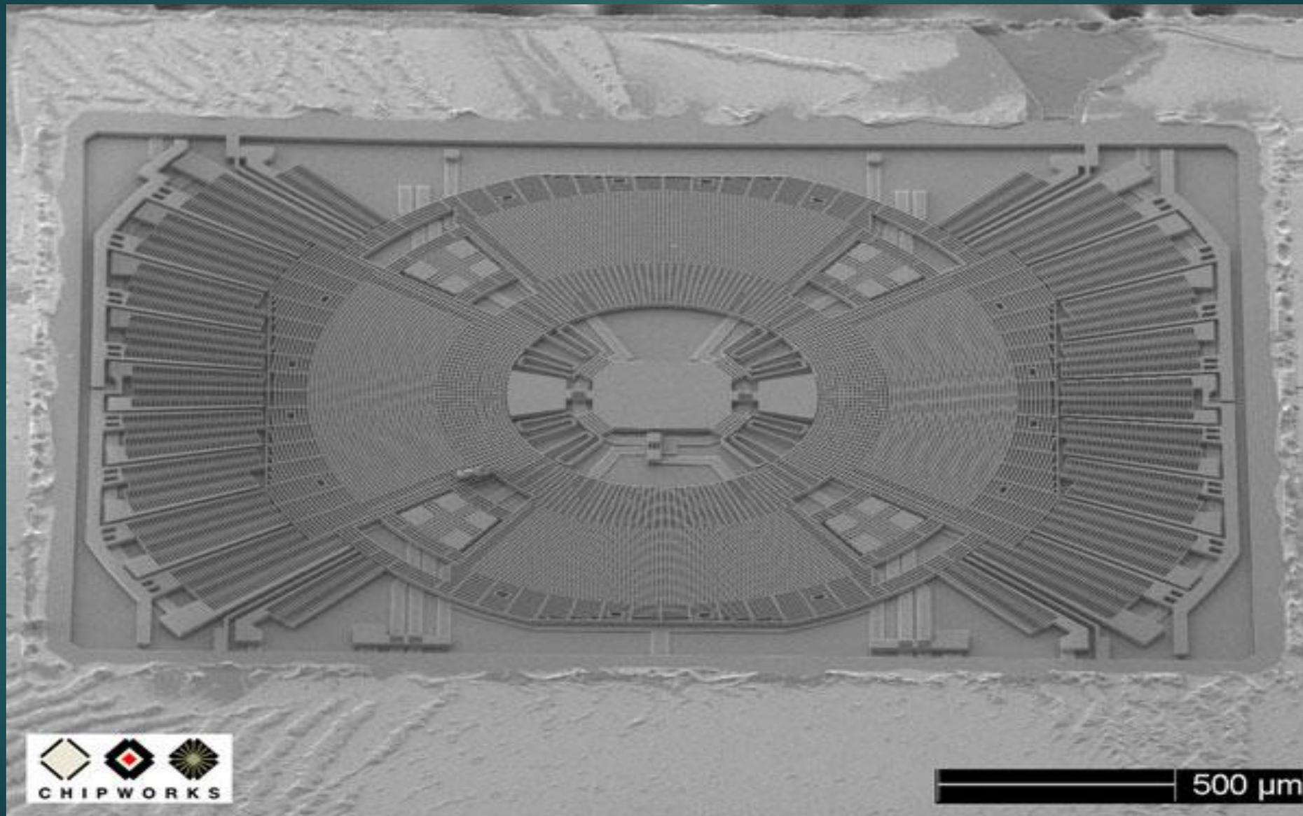
Крупный план STM LYPR540AH. Толщина деталей этой ажурной конструкции – около 3 микрон!
