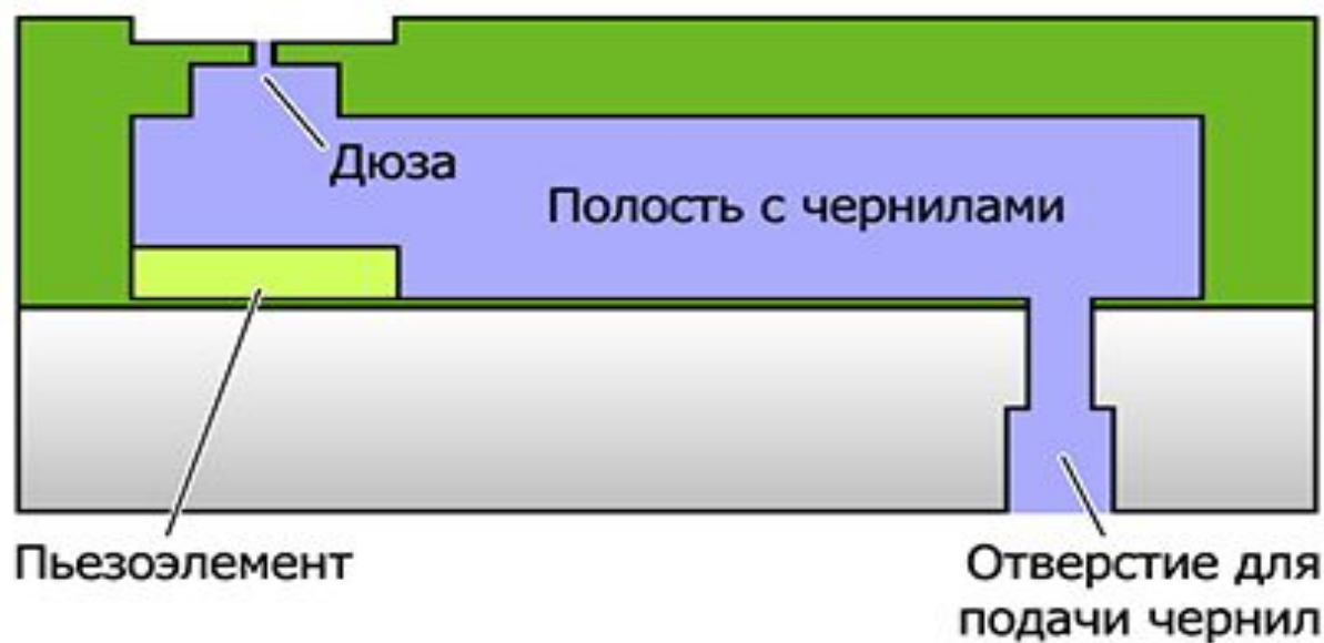
Принцип работы пьезоструйной печатающей головки
