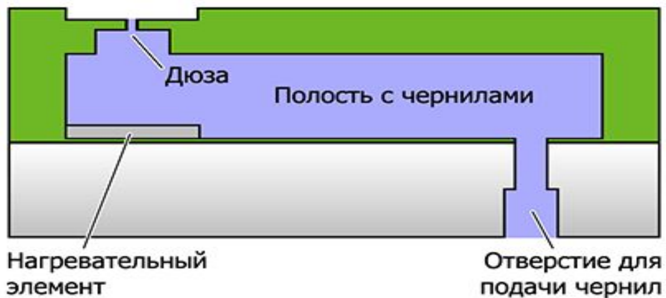
Принцип работы термоструйной печатающей головки
