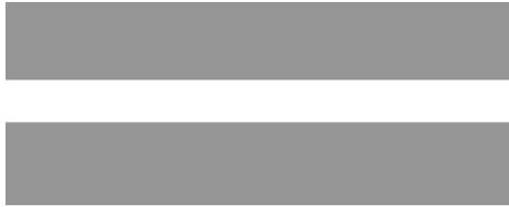
1.12 (стоп-линия) - указывает место, где водитель должен остановиться при наличии знака 2.5 или при запрещающем сигнале светофора (регулирущика);
