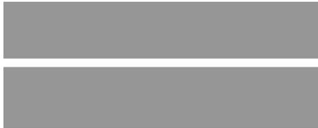
1.1 - разделяет транспортные потоки противоположных направлений и обозначает границы полос движения в опасных местах на дорогах; обозначает границы проезжей части, на которые въезд запрещен; обозначает границы стояночных мест транспортных средств; Линию 1.1 пересекать запрещается.
