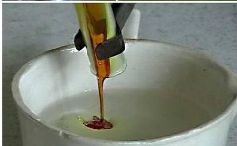
При нагревании ромбическая сера превращается в пластическую.
