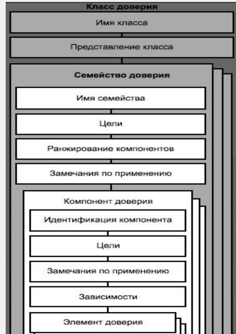
Иерархическая структура представления требований доверия: класс-семейство-компонент-элемент
