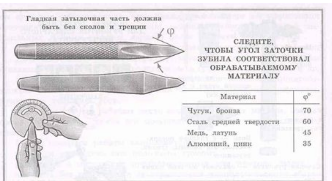
Рис. 2. Требования к зубилам и крестовидным отверткам
