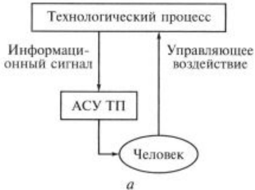
Рисунок 1.1 – Автоматизированная (а) и автоматическая (б) системы управления
