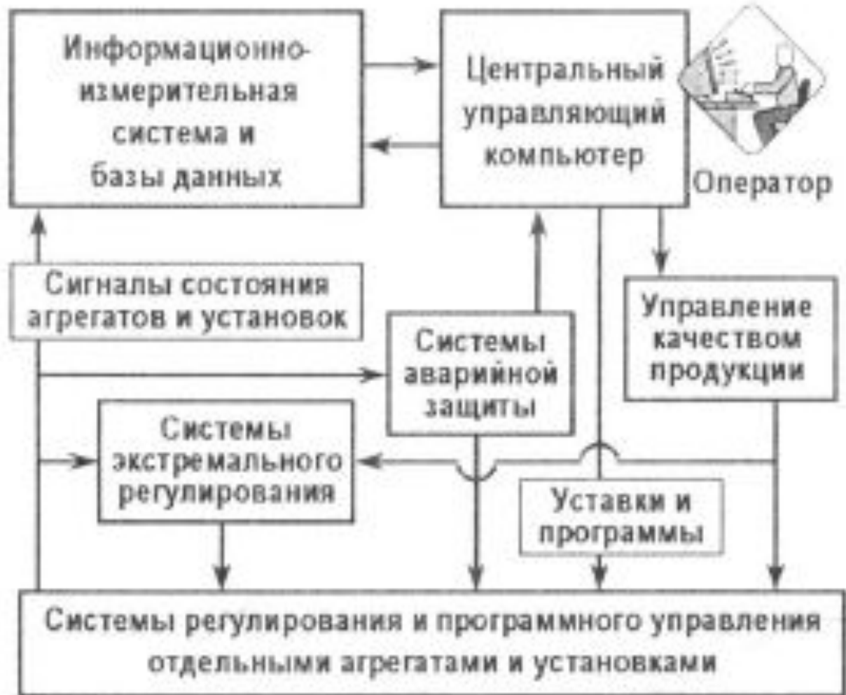
Рисунок 1.2 – Структура автоматизированной системы управления
