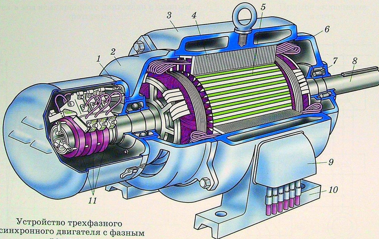
Устройство трехфазного асинхронного двигателя с фазным ротором:
