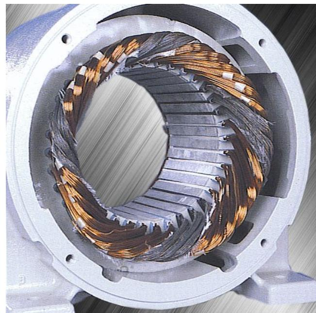
Устройство статора асинхронной машины
