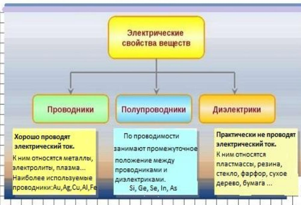
По способам проводить электрический заряд, вещества делятся на проводники, полупроводники и диэлектрики.
