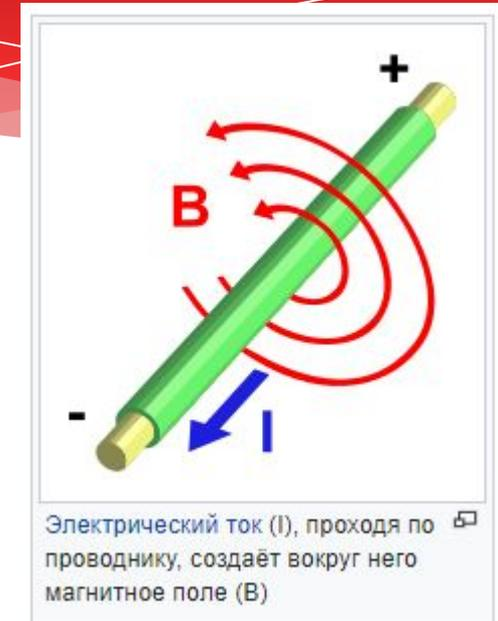
Электрический ток (I), проходя по проводнику, создаёт вокруг него магнитное поле (B)
