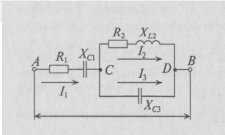
Определить сопротивление, проводимости, токи, мощности (активную, реактивную, полную) ветвей и цепи.
