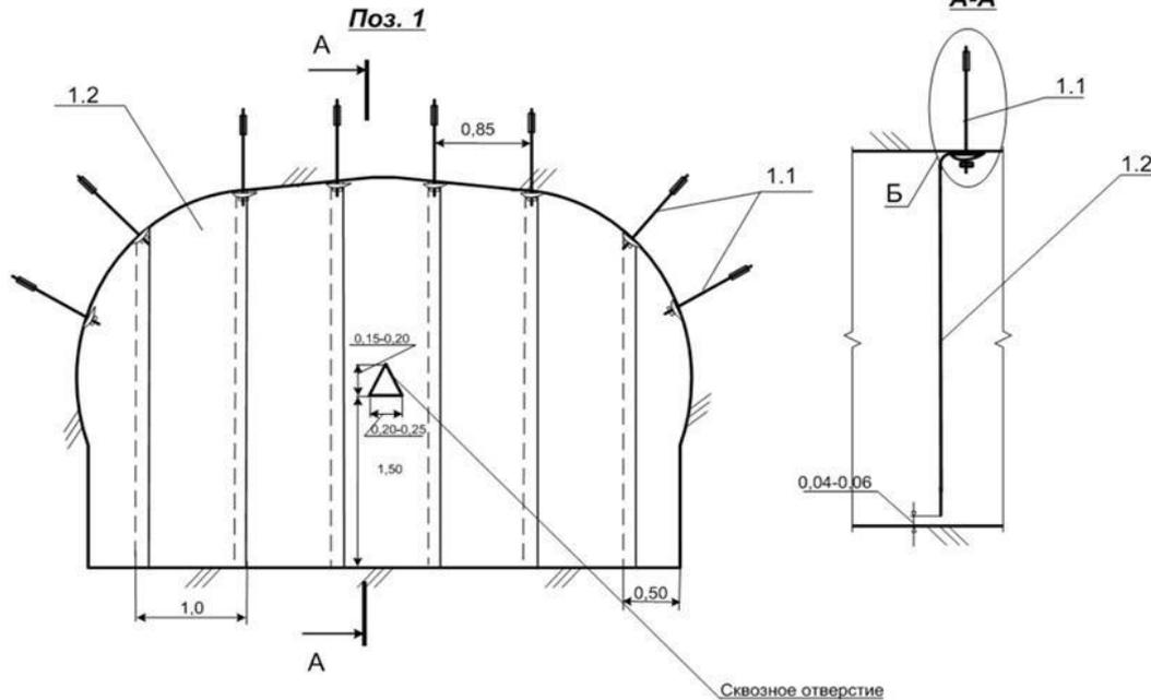
Спецификация на вентиляционную перемычку
