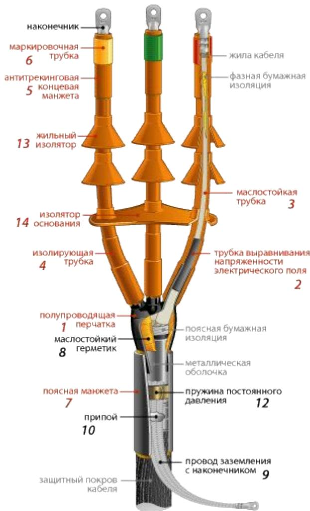
Здесь подробно расписаны все части концевой кабельной муфты (монтируется на концах кабеля)
