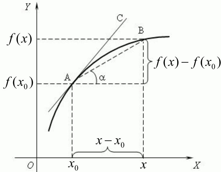
Если существует предел углового коэффициента секущей АВ при  $x \rightarrow x_0$ , то прямую АС, которая проходит через точку А и имеет угловой коэффициент  $k$ , равный этому пределу, называют в этом случае предельным положением секущей или касательной в точке  $(x_0, f(x_0))$  графика функции.
