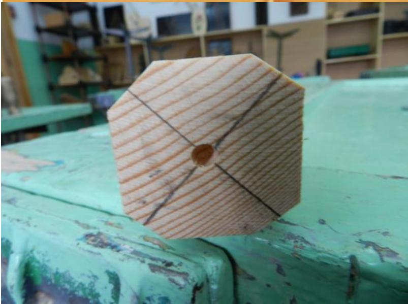
Установить заготовку на токарный станок
