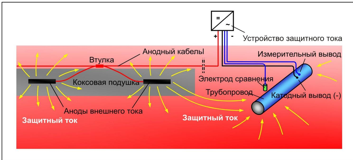
Защитный ток от подключенного к сети устройства защитного тока течет над поверхностью грунта от анода, помещенного в коксовую подушку, к поврежденным участкам покрытия трубопровода и предотвращает воздействие коррозии. Установленный рядом с трубопроводом электрод сравнения с продолжительным режимом работы измеряет потенциал защитного объекта и в долгосрочной перспективе наблюдает за соблюдением требований к защите и эффективностью работы системы КЗК.
