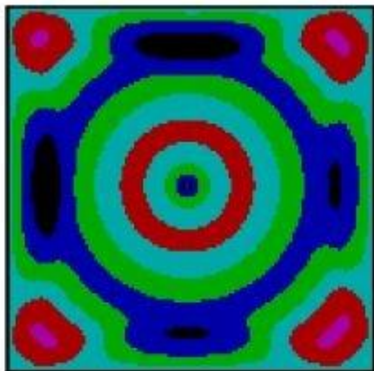
Рис. 5. Вынужденные колебания пластины квадратной формы.
