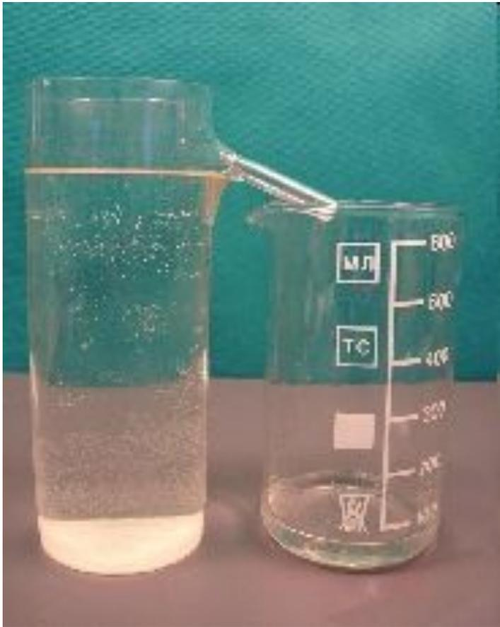
При погружении тела в отливной стакан с водой, вода выливается. Объем этой воды равен объему погруженного тела.
