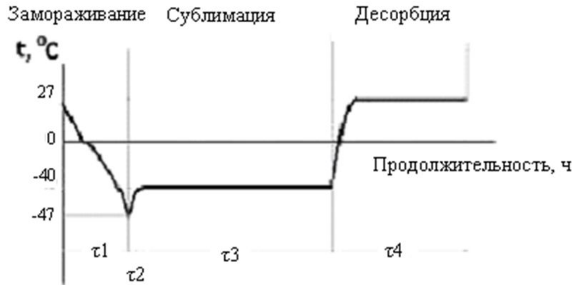
Рисунок 6.23 График температурной кривой высушивания бактериальной массы ацидофильных лактобактерий
