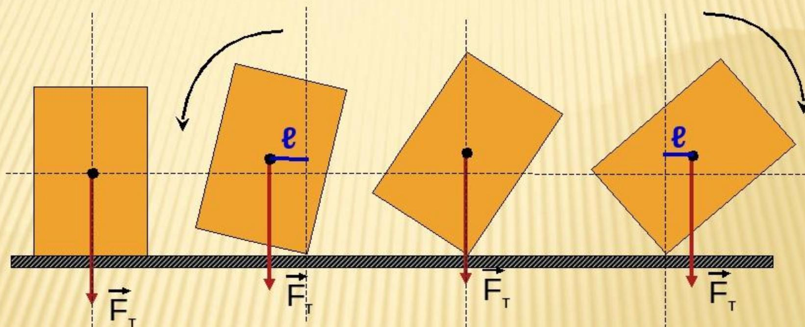
Тело, имеющее площадь опоры, будет находиться в равновесии до тех пор, пока линия действия силы тяжести будет проходить через площадь опоры.
