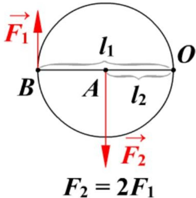
**Подвижный блок** – это блок, ось которого поднимается и опускается вместе с грузом
