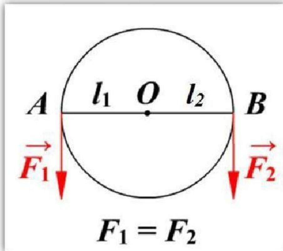
**Неподвижный блок** – это блок, ось которого закреплена и при подъеме грузов не опускается и не поднимается
