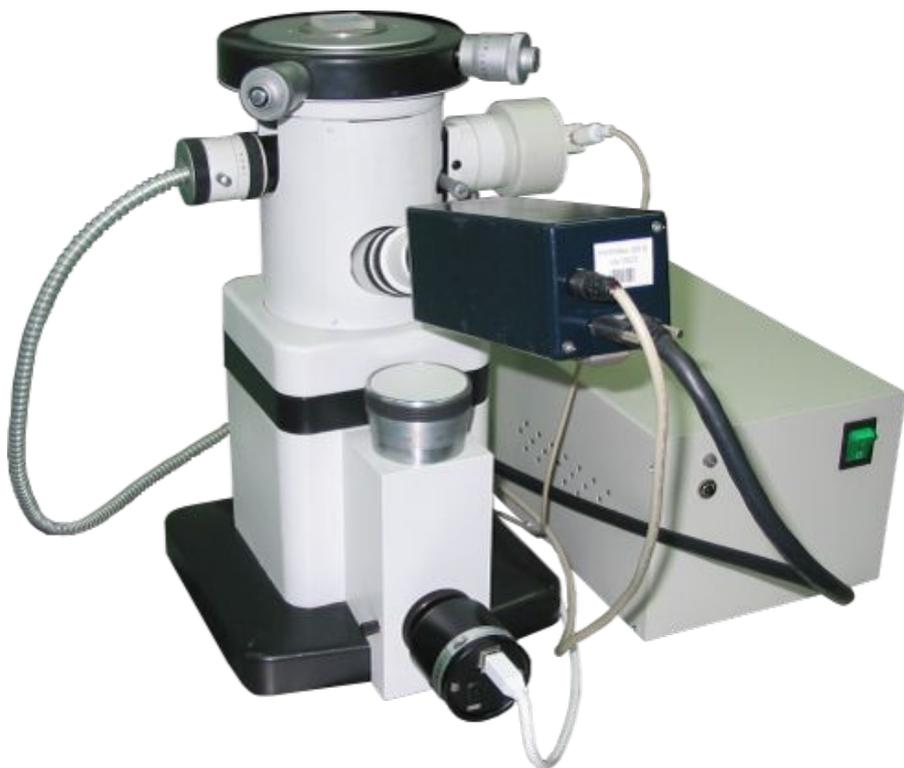
Диапазон измерения прибора находится в пределах от **0,03 до 1 мкм** и оценивается по параметрам ***Ra***, или ***Rmax***.
