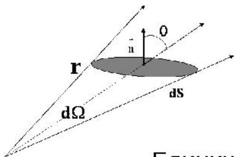
Освещенность  $E$  связывает световой поток с площадью той поверхности, на которую этот поток падает.
