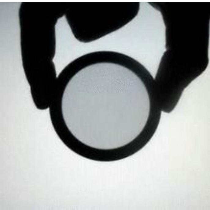
**Ограничить прохождение поляризованного света можно простым поворачиванием фильтра.**
