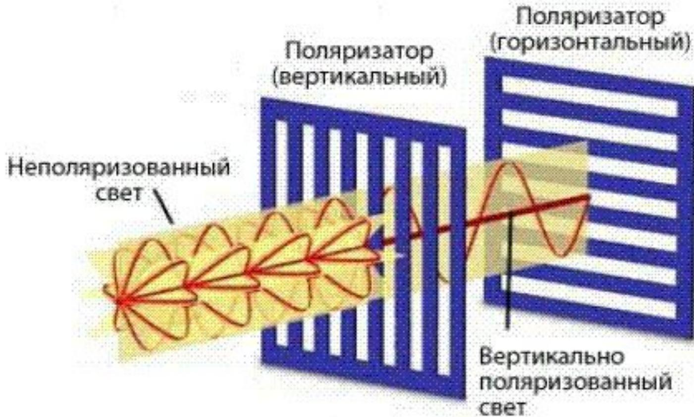
После прохождения света через вертикальный поляризатор электрический вектор светового потока не может пройти через горизонтальный поляризатор. В результате получается светофильтр ограничивающий свет для глаз наблюдателя.
