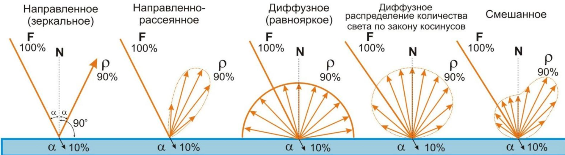
Характер отражения определяется структурой материала, состоянием его поверхности, типом поляризации падающего света и т.д.
