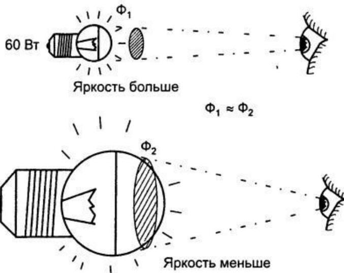
Для того, чтобы глаз не подвергался действию яркого света источника, можно колбу лампочки накаливания сделать из матового стекла или прикрыть арматурой в виде молочного шара, чтобы излучаемый ею световой поток исходил с большей поверхности.
