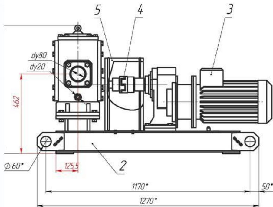
**Насосный агрегат** состоит из шестеренного насоса ДС-185 поз. 1 установленного на раме поз. 2 и соединенного с двигателем поз. 3 посредством муфты поз. 4. Муфта защищена защитным устройством (кожухом) поз.5.
