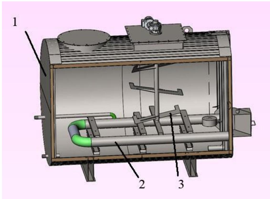
1 – корпус цистерны; 2 – жаровые трубы; 3 – лопастная мешалка
