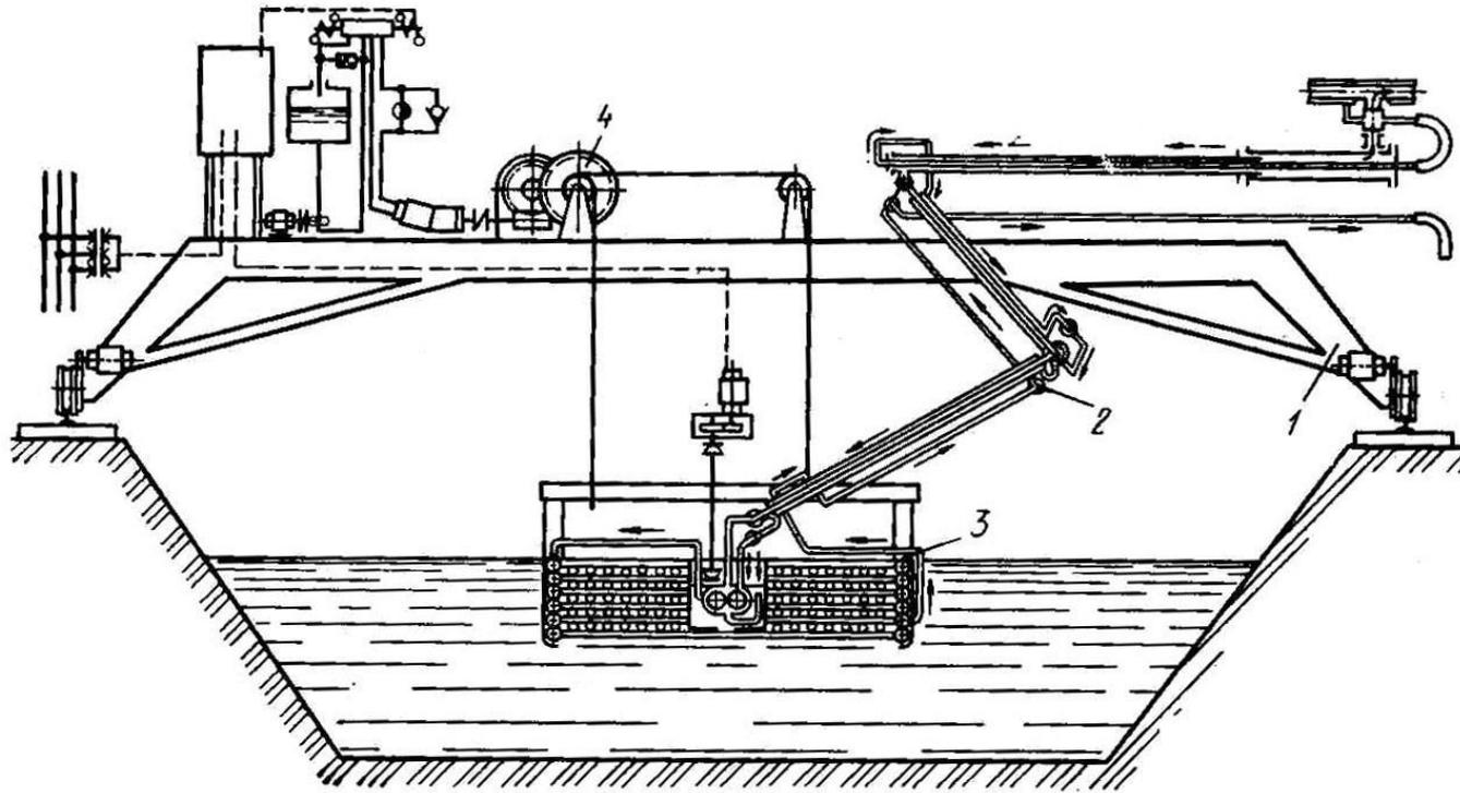
Нагревательно-перекачивающий агрегат имеет возможность передвигаться вдоль битумохранилища. На мосту 1 агрегата установлены лебедки 4 подъема и опускания подогревателя и система битумопроводов 2. Разогреватель имеет набор трубчатых регистров 3, по которым последовательно проходит теплоноситель – воздушный пар. На раме агрегата установлен также битумный насос для перекачивания битума.
