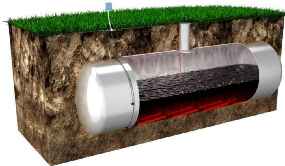
**Горизонтальная битумная цистерна** предназначена для хранения и разогрева битума огневым способом. В цистерне устанавливается жидкотопливная горелка, для минимизации теплопотерь котел обшит слоем утеплителя толщиной 100 мм. Наружная обшивка выполнена из профлиста. Котел оборудован люком, патрубками приема/выдачи битума.
