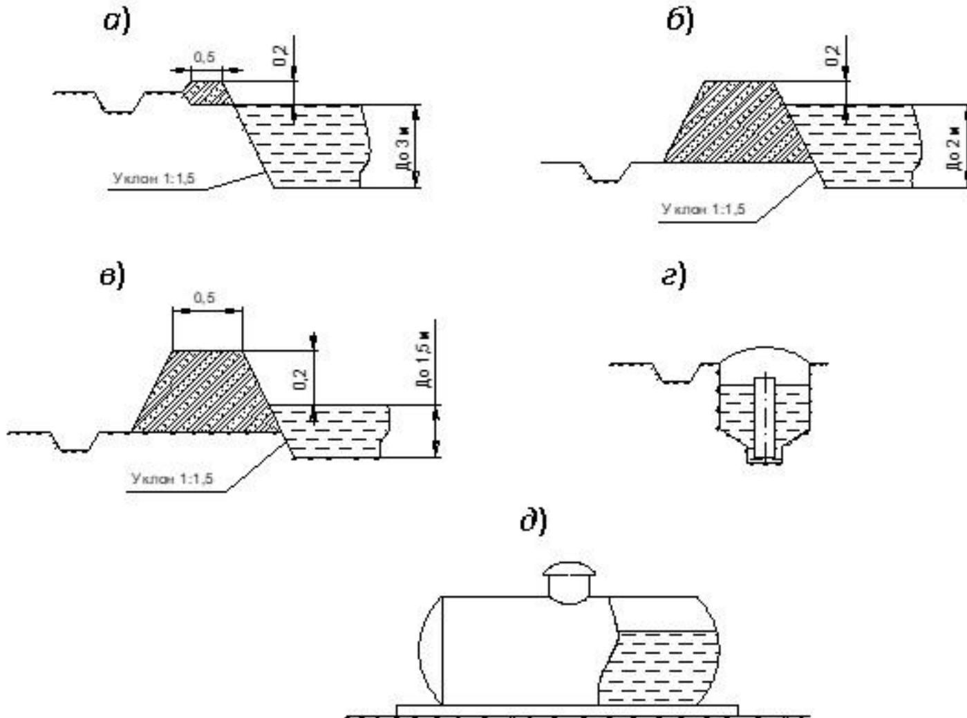
*а – ямного; б – полуямного; в – наземного; г – подземного; д – передвижное инвентарное*
