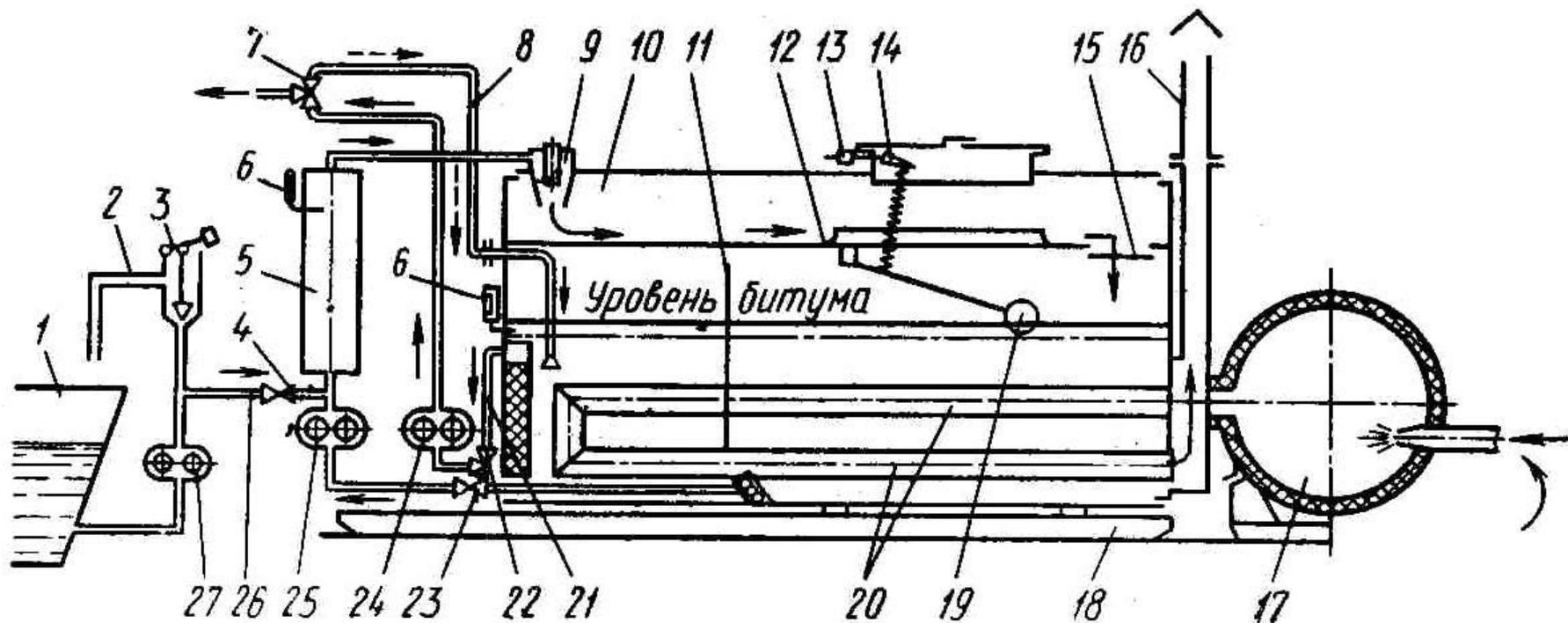
1 – битумохранилище; 2 – возвратный битумопровод; 3 – предохранительный клапан; 4, 22, 23 – краны;
