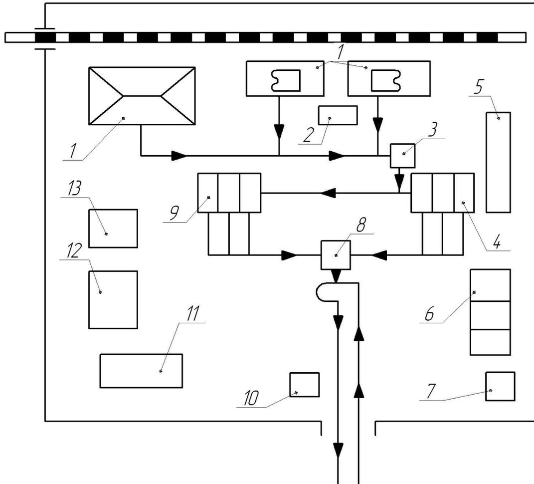
1 – битумохранилища крытого типа с нагревательно-перекачивающими агрегатами; 2 – преобразователь;
