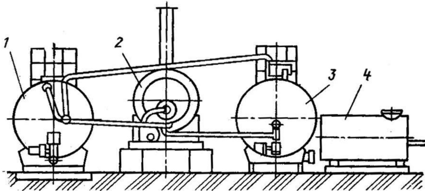
Нагреватели битума часто комплектуют из нескольких агрегатов . В состав нагревателя входят: расходная битумная емкость 1, трубчатый нагреватель 2, резервуар обслуживания 3, топливный бак 4 с топливной системой, пульт управления и битумопроводы.
