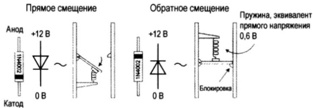
РИС. 4.13. Водяная аналогия диода (а) и кривая зависимости тока диода от напряжения (б). МОП — максимальное обратное напряжение; I_{пр} , U_{пр} — ток и напряжение прямого смещения; I_{обр} , U_{обр} — ток и напряжение обратного смещения
