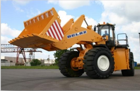
Погрузчики Емкость ковша 3.75-11 м 3
