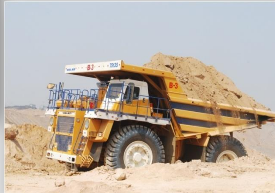
Серия самосвалов БЕЛАЗ-75135 Грузоподъемность: 110 тонн
