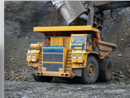
Серия самосвалов БЕЛАЗ-7513 Грузоподъемность: 136 ТОНН
