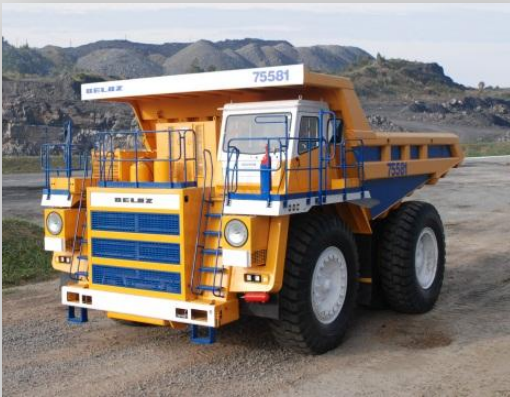
Серия самосвалов БЕЛАЗ-7558 Грузоподъемность: 90 тонн
