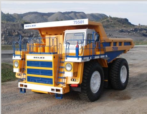
Серия самосвалов БЕЛАЗ-7558 Грузоподъемность: 90 тонн
