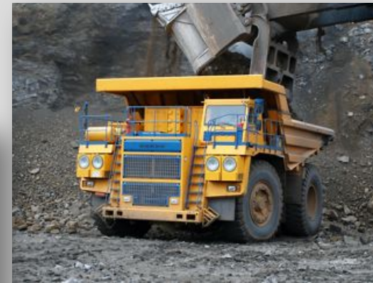
Серия самосвалов БЕЛАЗ-7513 Грузоподъемность: 136 ТОНН
