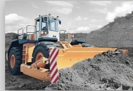
Бульдозеры Отвал 4.2-4.8 м 3
