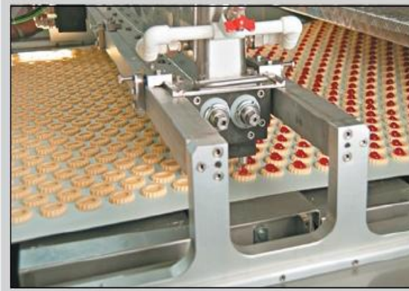
Рис. 39. Автоматическая линия по производству: а – печенье; б – конфет
