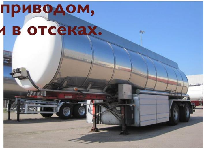
**Для высокотемпературных грузов (битум, асфальт, мазут, горячая сырая нефть) используются специальные цистерны из углеродистой стали, нержавеющей стали или алюминия. Теплоизоляция стенок позволяет долгое время сохранять температуру содержимого до 200°C**
