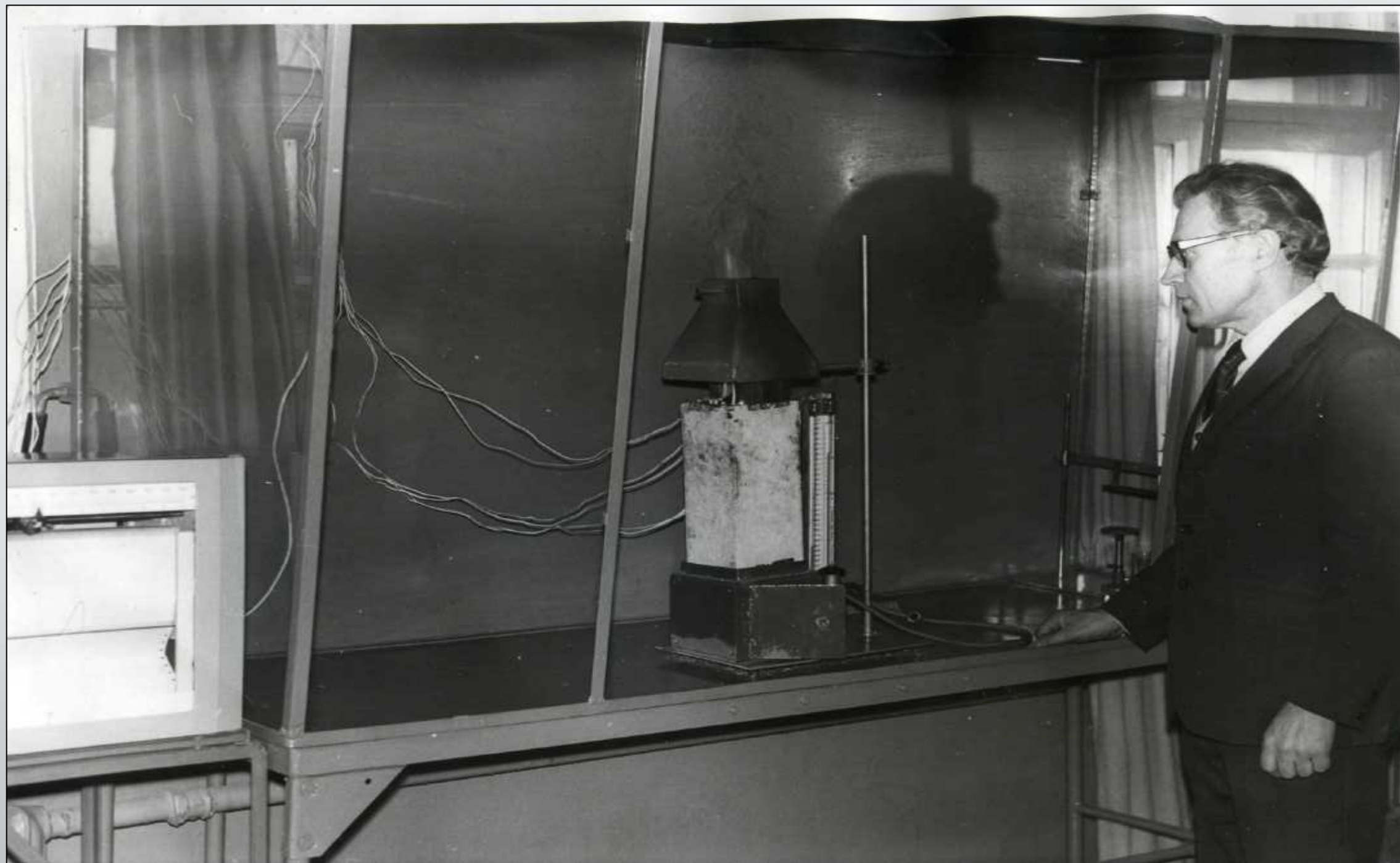
Испытание: эффективности огнезащиты образцов (пожарно-техническая станция УПО)
