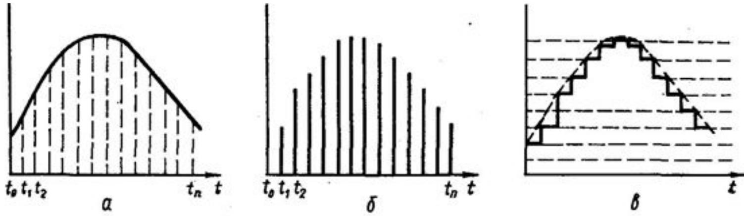
**Рис. 1 а) выделение мгновенных значений сигнала, б) дискретизация, в) квантование**
