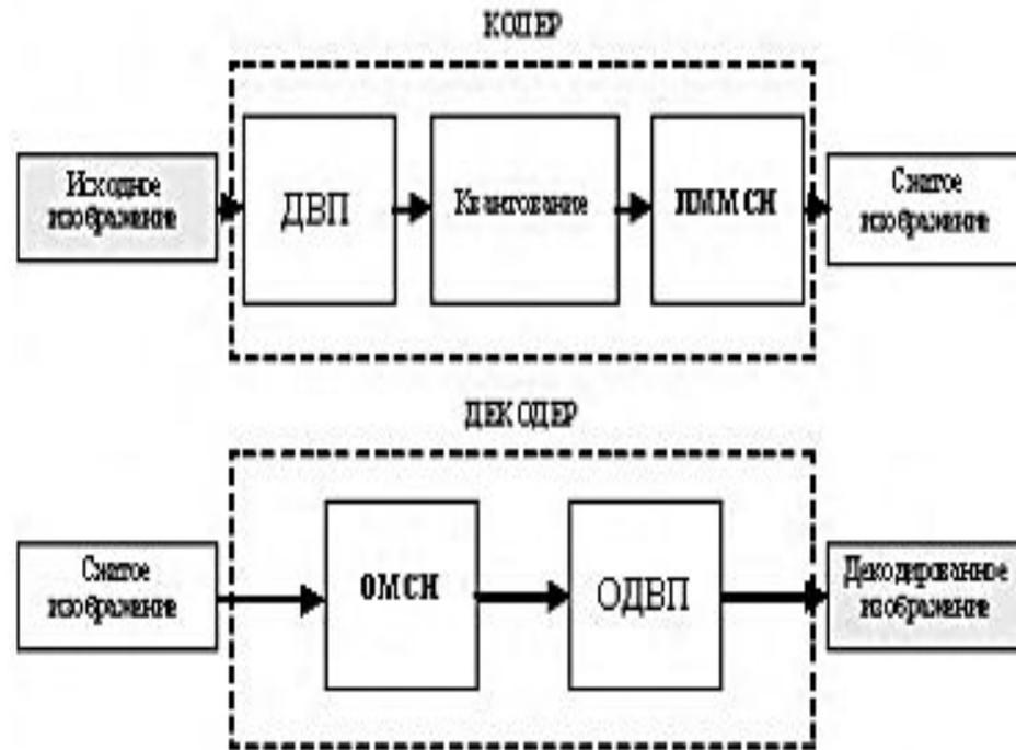
Схема кодирования и декодирования изображений посредством алгоритма сжатия изображений на базе вейвлет-преобразования
