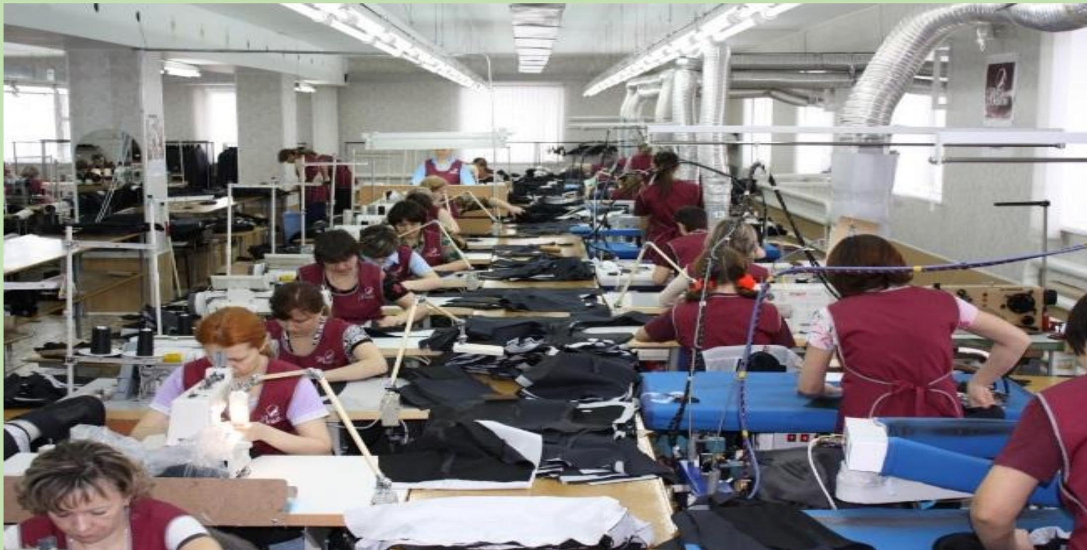
На участке изготовления кармана швея накладывает дублирующий материал на будущий клапан кармана пиджака. Дублиаж позволяет элементу одежды долго сохранять форму и предохраняет от растяжения.
