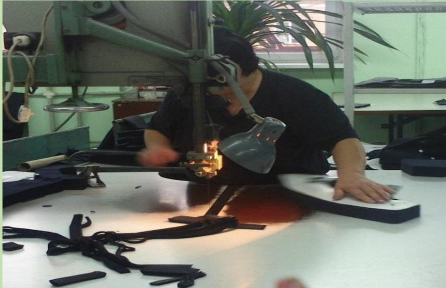
Дублирование производится на дублирующих установках проходного типа «Майер». Работница-оператор укладывает клеевую прокладку на деталь и направляет её на непрерывно движущуюся транспортную ленту.
