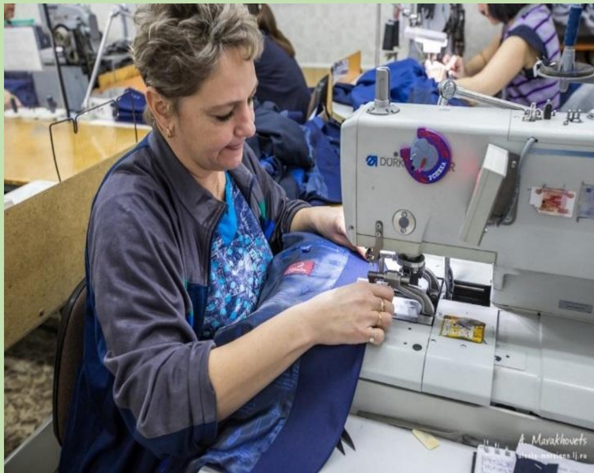
Сшивка подкладки воротника с дублирующим слоем для придания ему формы и жёсткости.
