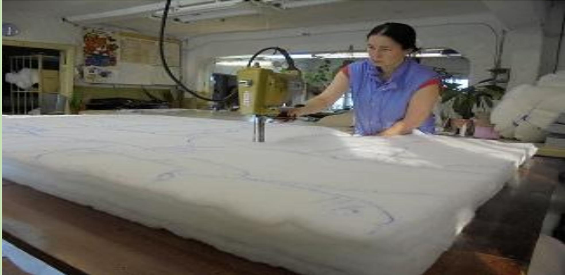
Такое раскройное оборудование используют для вырезания мелких деталей и деталей сложных конфигураций из предварительно рассеченных частей настила. Здесь работница делает осноровку деталей по лекалам из картона.
