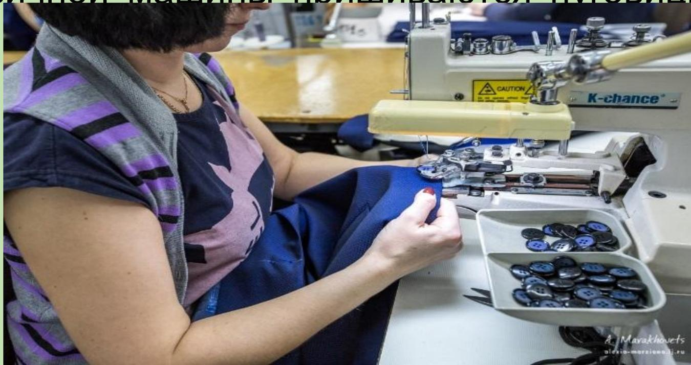
А это закрепочный и петельный автомат с глазком. Они всегда работают в паре. Внутри обмётанной петли проходит каркасная нить. Центр петли автоматически прорезается при помощи специального ножа и глазок выдавливается. Затем по концам нитей на петле нужно поставить закрепку. Так получается качественная и очень красивая петля.
