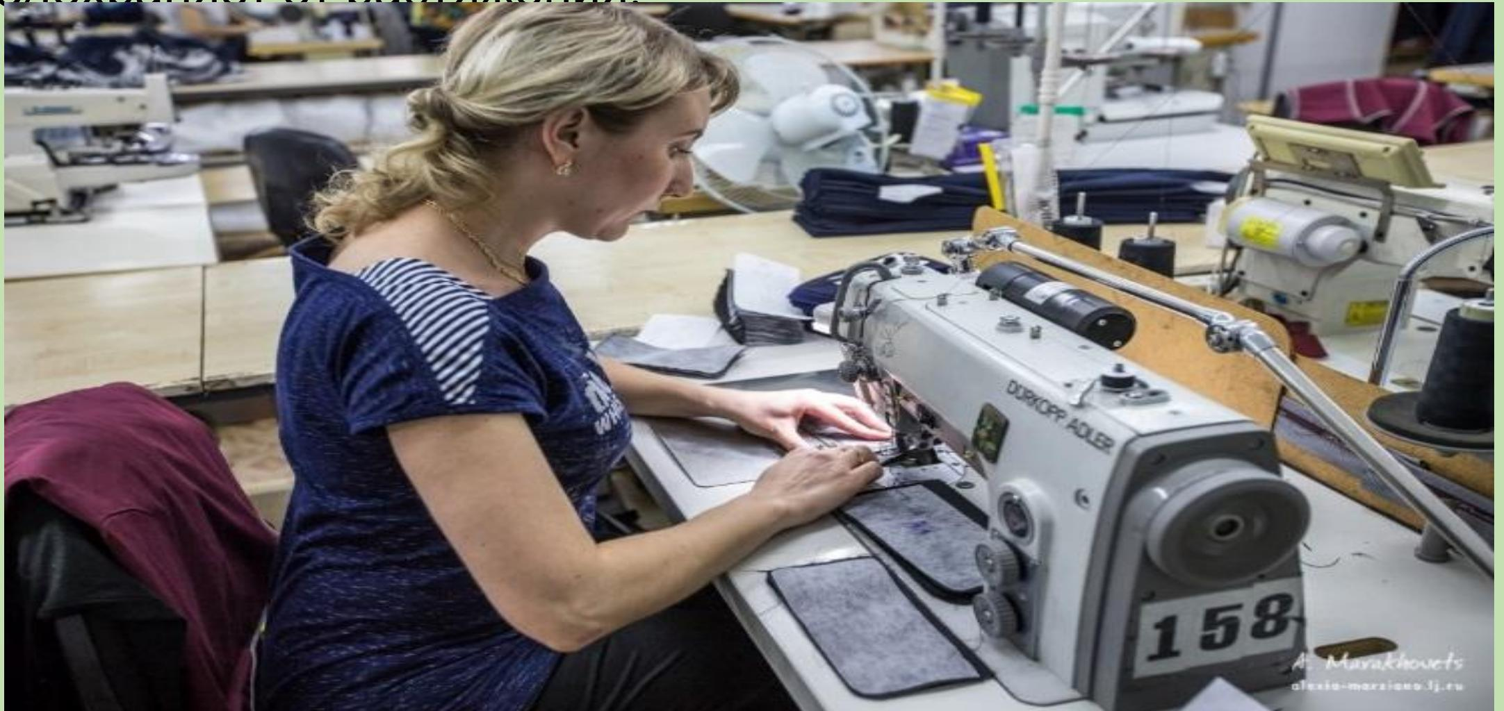
Заготовка клапана поступает швее, которая с помощью специального автомата пришивает его к другой заготовке. Лазерная линейка автомата позволяет расположить клапан очень ровно. Мгновение — и клапан на месте. Другая швея прорежет под ним ткань, сформировав тем самым карман.
