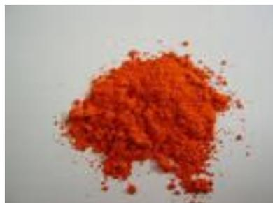
**оксид свинца  $\text{Pb}_3\text{O}_4$**
