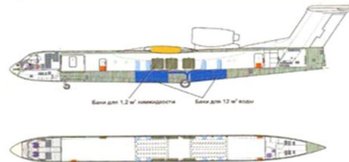
За время выработки одной полной заправки топливом самолет сбрасывает на очаг пожара 270 м<sup>3</sup> воды
