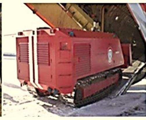
**Робототехнический комплекс повышенной проходимости для обеспечения пожаротушения и проведения пожарно-спасательных операций в условиях радиационно - химического заражения и риска осколочно-фугасного поражения
