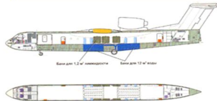
За время выработки одной полной заправки топливом самолет сбрасывает на очаг пожара 270 м 3 воды
