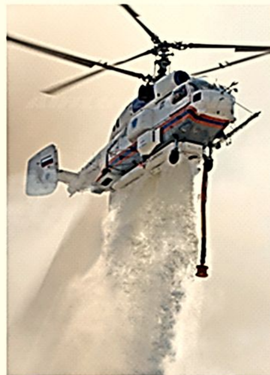
Пожарно-спасательный вертолет Ка-32А. Сброс воды
