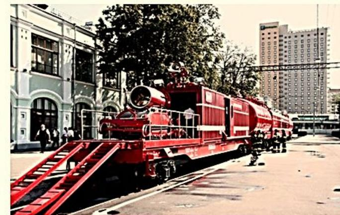
Важной особенностью мобильной установки Luf-60 является ее способность перемещаться как по рельсам, так и на гусеничном ходу со скоростью до 6 км/ч, создавая при этом мелкодисперсный распределенный поток воды, уничтожающий очаг возгорания и вытесняющий дым из тоннеля.
