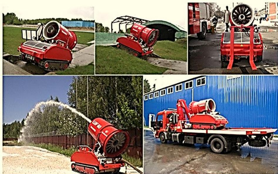
предназначена для тушения пожаров в автодорожных и железнодорожных туннелях, в метрополитене, в гаражах, производственных и складских помещениях – везде, где стандартная стратегия тушения пожаров с использованием людей представляется опасной, то есть непосредственно в очаге пожара.
