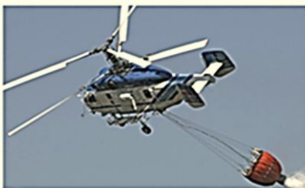
Пожарно-спасательный вертолет Ка-32А с ВСУ-5
