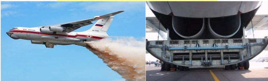
Ил-76П оснащён легкосъёмной системой, состоящей из 2-х баков ВАП-2 (**выливной авиационный прибор**), каждый объёмом 21000 л (в пожарный может быть переоборудован практически любой транспортный Ил-76). Общая масса системы ВАП-2 из двух баков с водой составляет 45 т.
