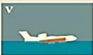
V При заполнении баков вода начинает выливаться из специального клапана
