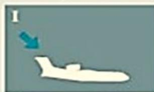
I Самолет снижается над водной поверхностью с минимально возможной скоростью
