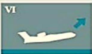
VI Пилот видит струю воды, закрывает водозаборные устройства и взлетает
