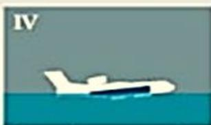
IV Вода набирается в баки через водозаборные устройства со скоростью около 1 т в секунду
