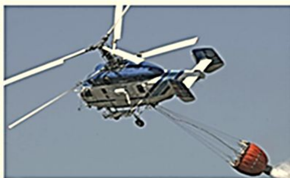
Пожарно-спасательный вертолет Ка-32А с ВСУ-5
