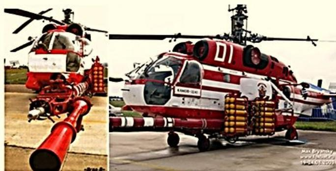
Объем воды в баках под полом вертолета составлял 740 л. С внешней стороны фюзеляжа по левому борту крепилась батарея баллонов со сжатым воздухом. Заявляемая разработчиком дальность «выстрела» – около 50 м.
