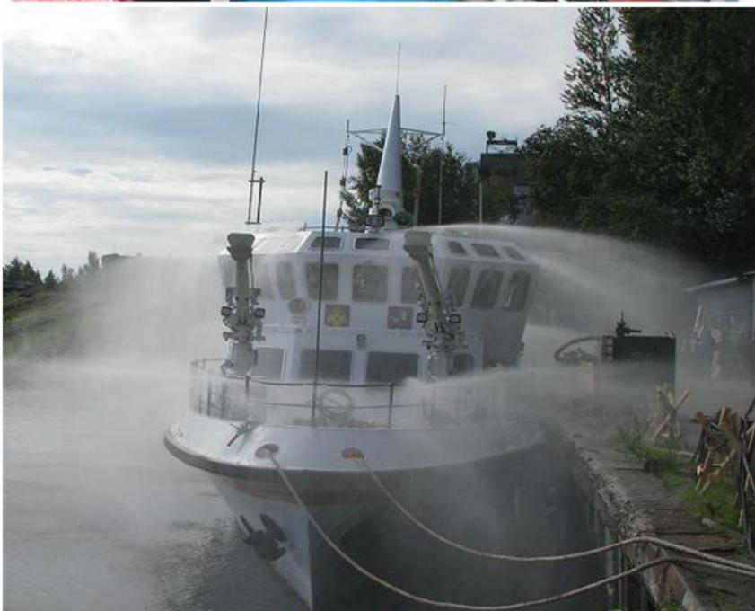
Корабль оборудован системой водяной завесы
