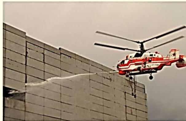
Дальность струи из **горизонтальной телескопической водо-пенной пушки** составляет около 45 метров, при производительности 40 л/сек. Это позволяет, как производить тушение водой или пеной верхних этажей высотных зданий, так и распылять воду на очаг пожара, не входя, непосредственно, в зону горения.
