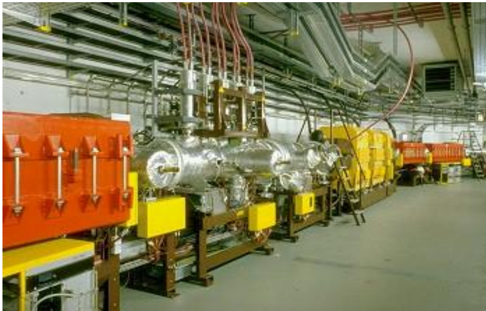
Рис. 2. Фрагмент ускорительного кольца протонного синхротрона на энергию 7 ТэВ (ЦЕРН, Швейцария)
