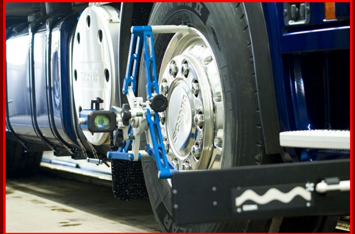
Стенд для диагностики управляемых колёс грузовых автомобилей
