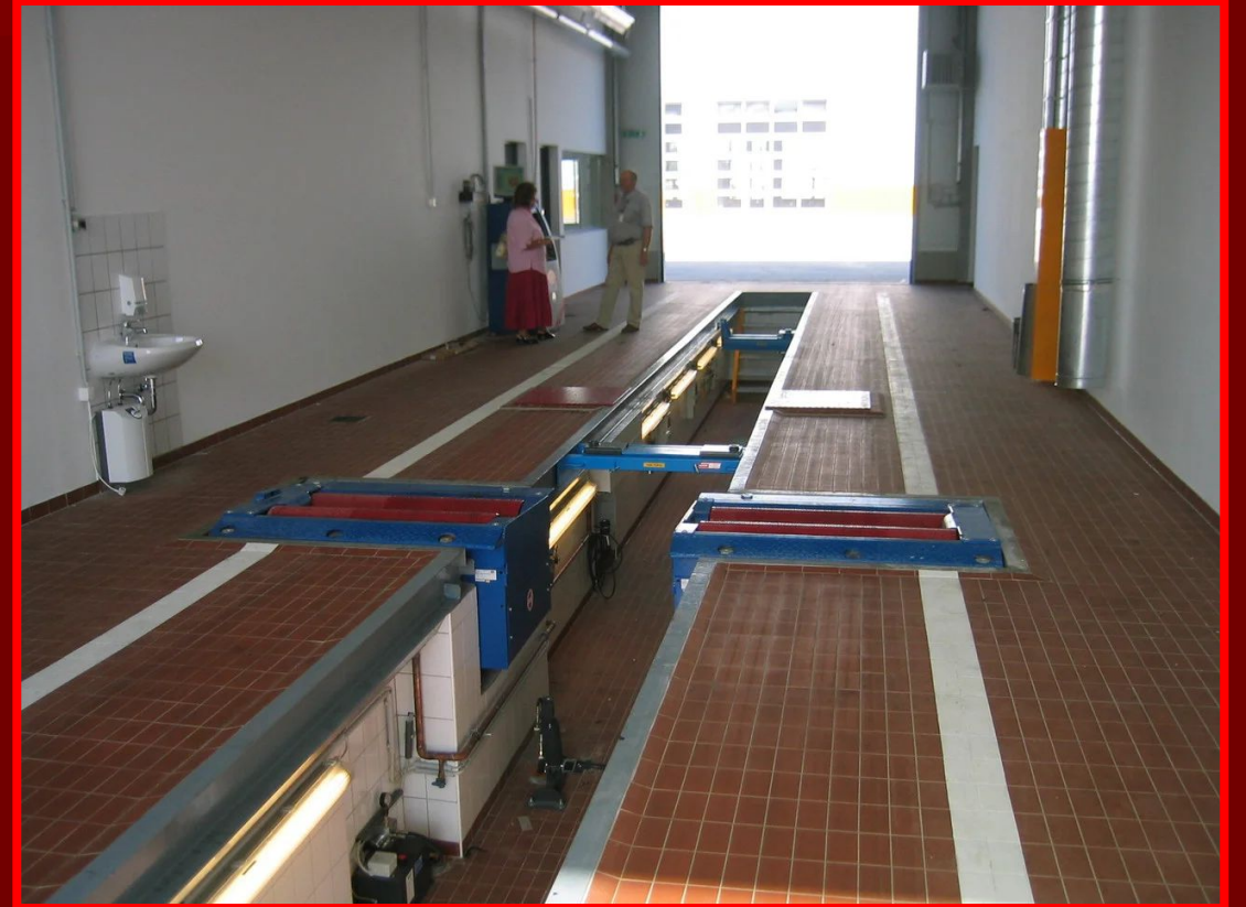
Силовой барабанный тормозной стенд модели КИ-4998
