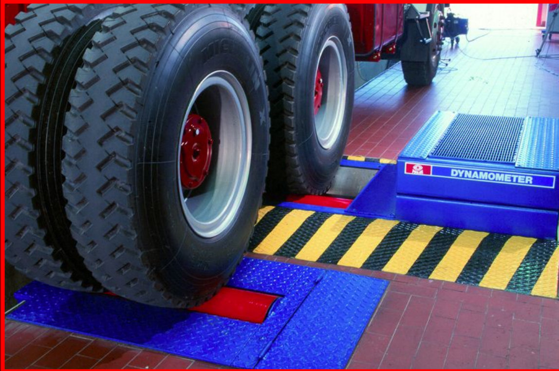
Стенд для диагностики тормозов грузовых автомобилей
