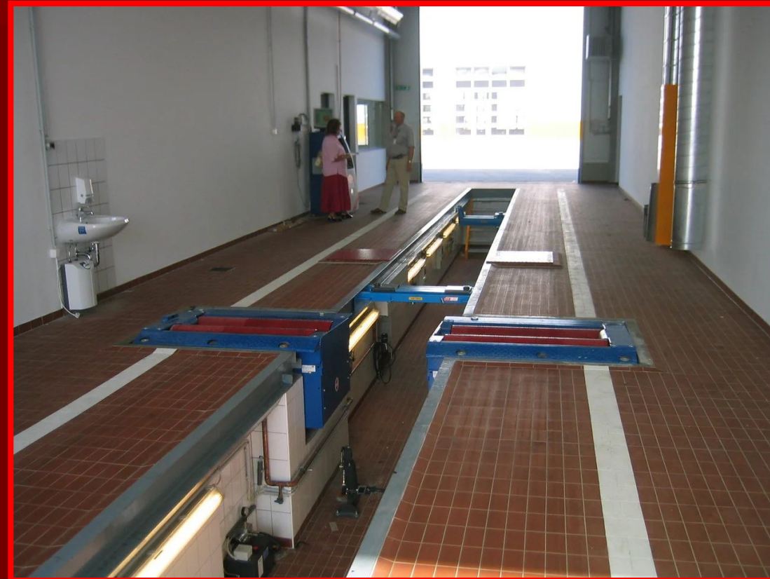
Силовой барабанный тормозной стенд модели КИ-4998
